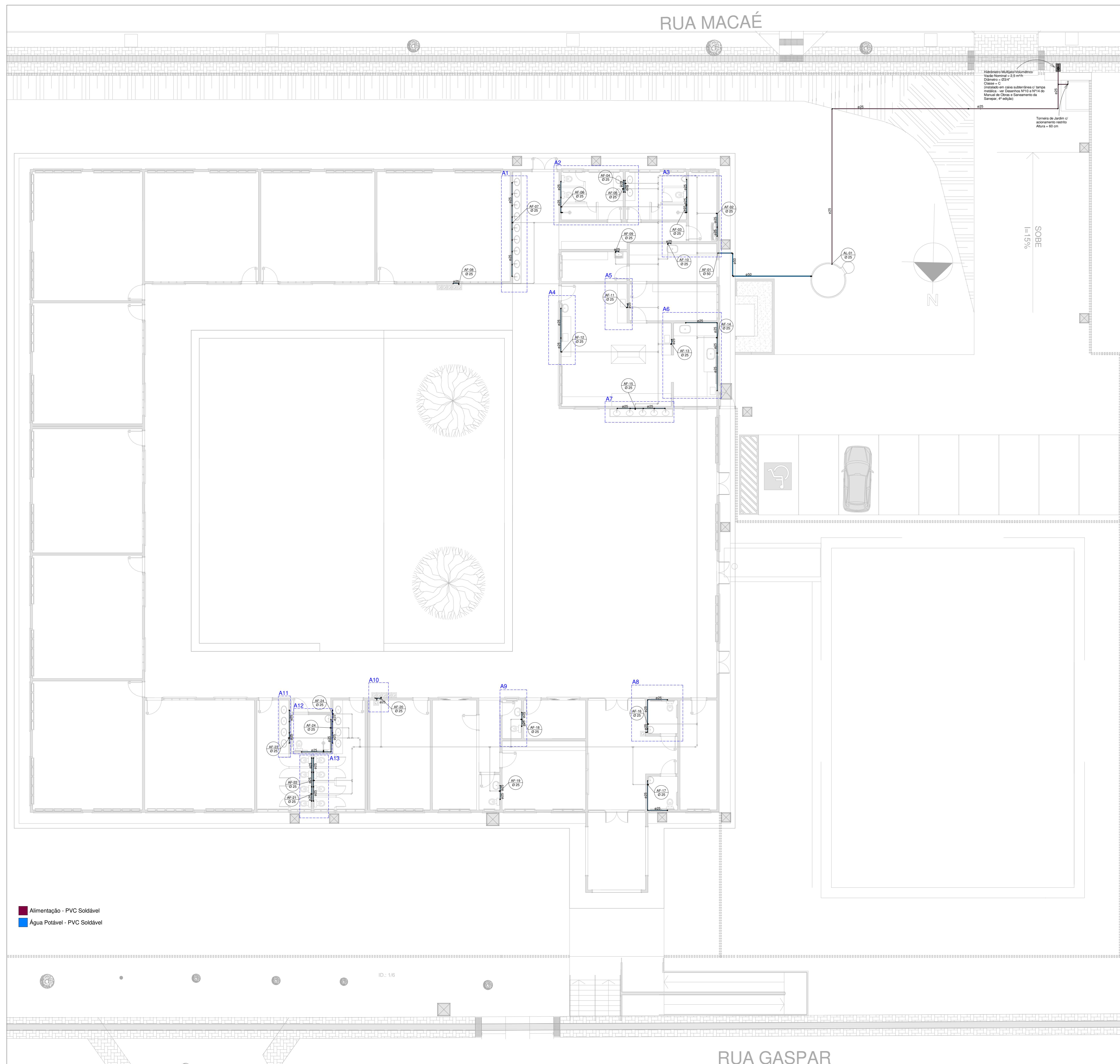
1 Água Fria - Planta Baixa do Pavimento Térreo 1 : 100
