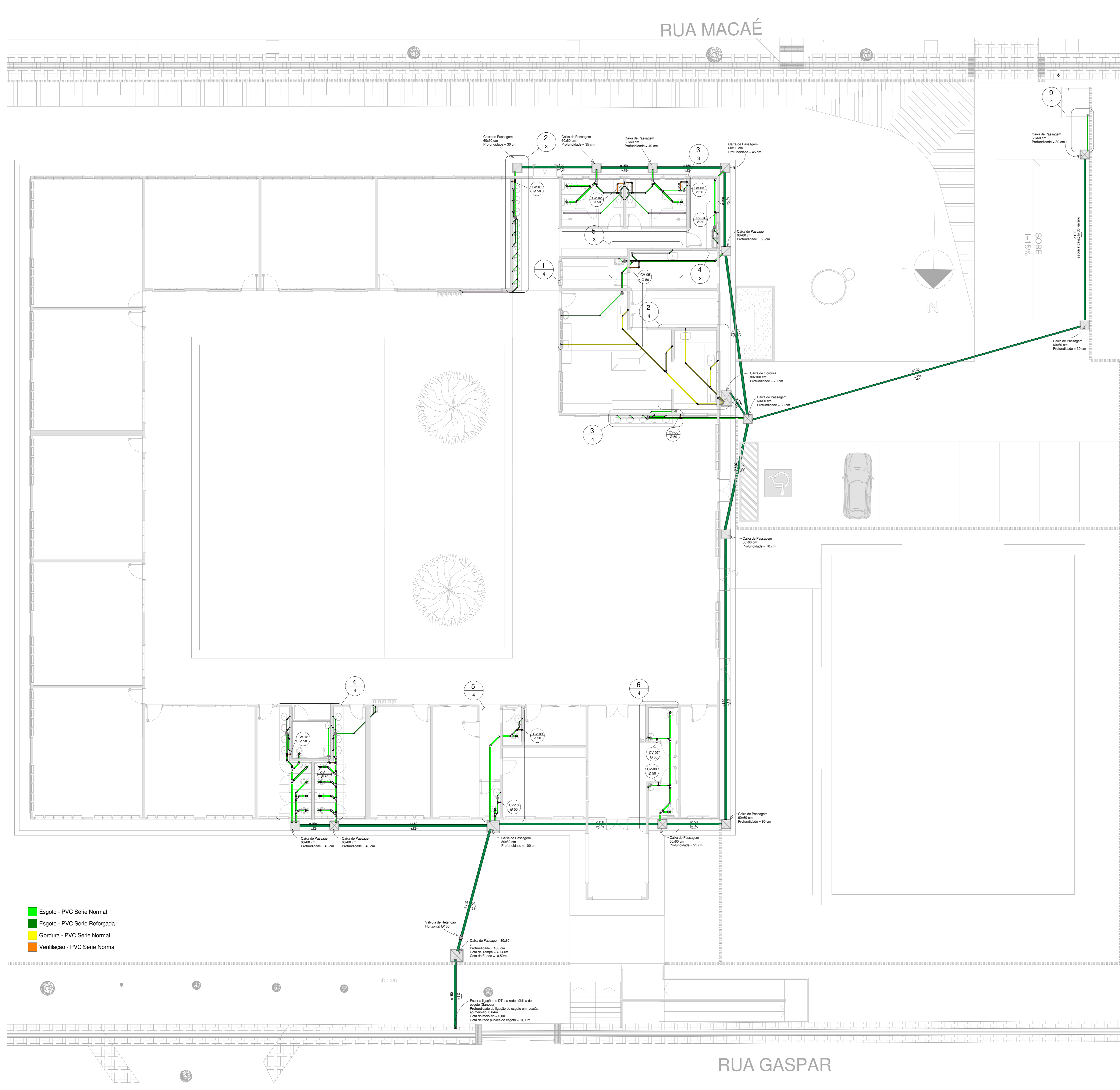
1 Esgoto - Planta Baixa do Pavimento Térreo 1 : 100
