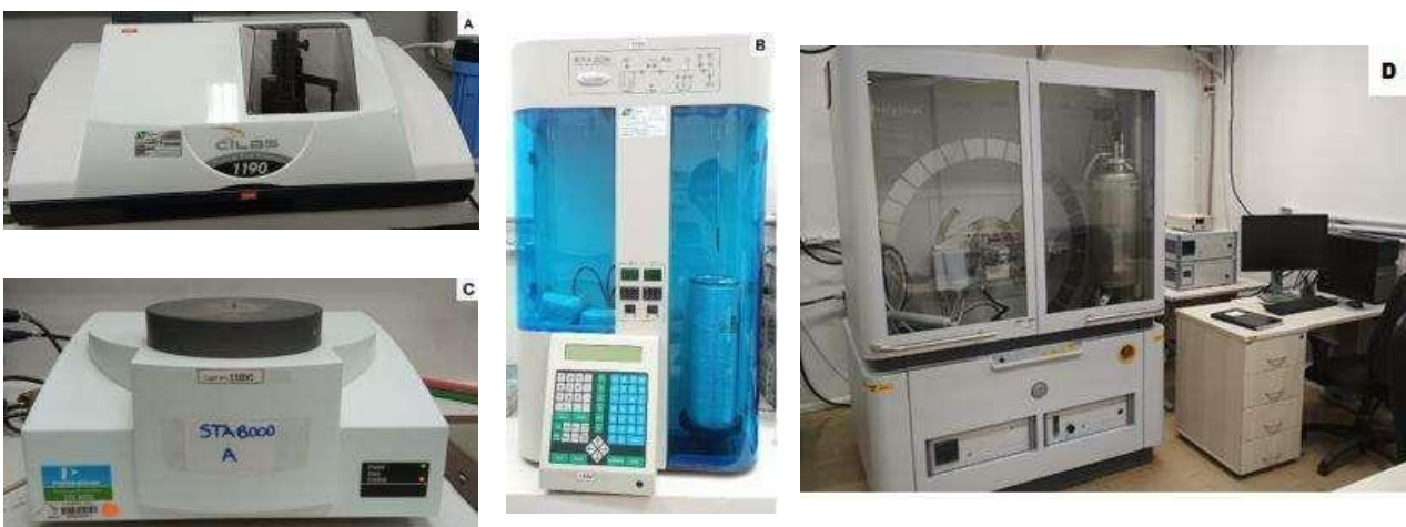
Figura 3.14 – A: Granulômetro à laser CILAS® 1190; B: Analisador de área superficial e poros QUANTACROMER® NOVA 3200e; C: Analisador térmico simultâneo PERKINELMER® STA 8000 e D: Difratômetro multipropósito EMPYREAN da PANalytical
