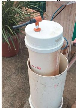
Figura 13: Remoção de gás do biodigestor
