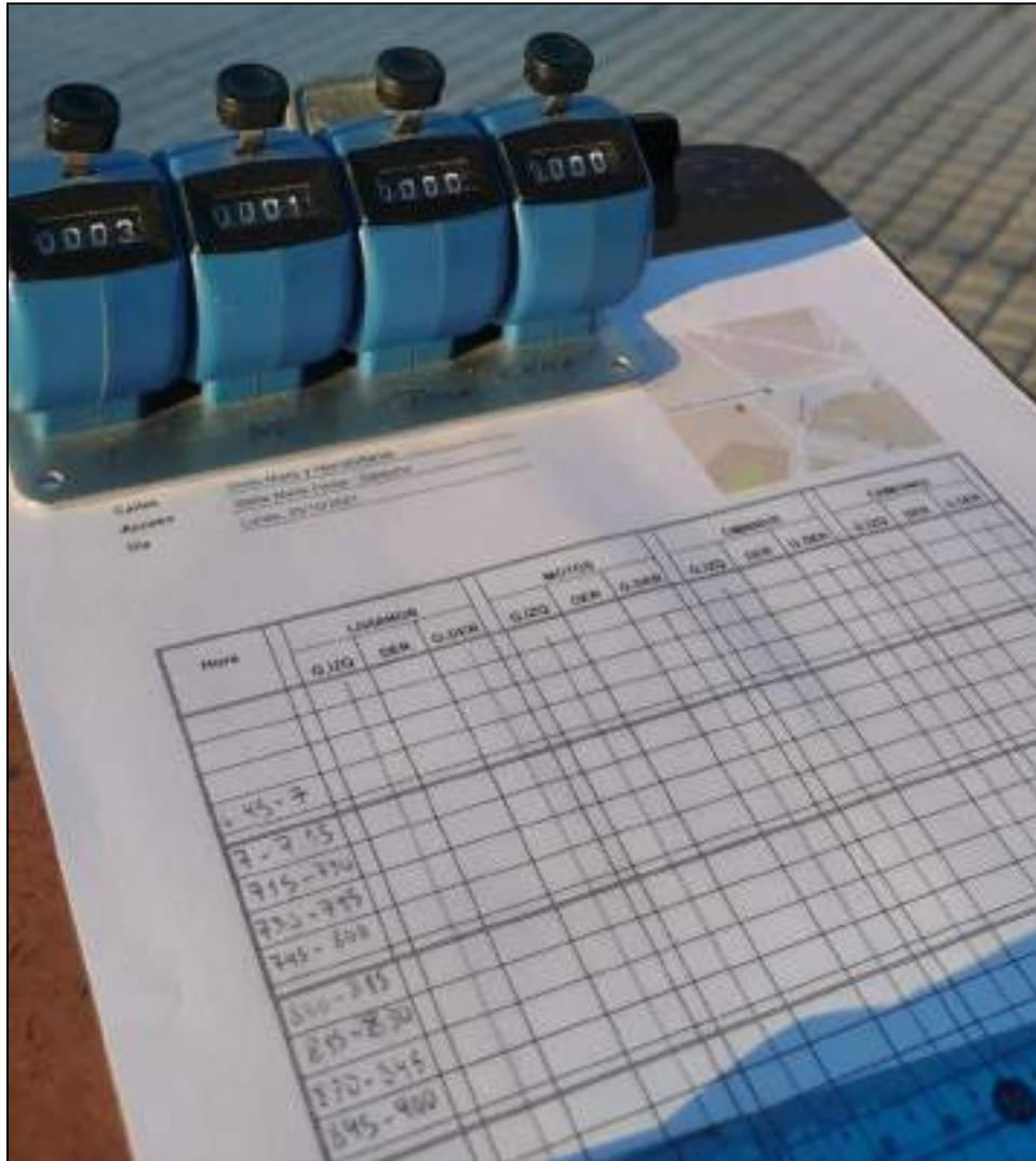
**Figura 13:** Contador Manual y Ficha de Conteo Volumétrico.
