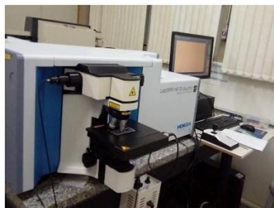
**(b) Espectrômetro Raman de alta resolução LabRAM HR Evolution, Horiba**
