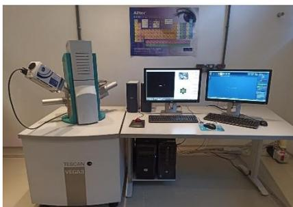
**(a) Microscópio Tescan-Modelo VEGA3**
