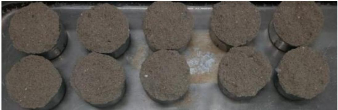
Registradas as forças de arrancamento e medidos os diâmetros de cada corpo de prova, foi montada a tabela 18, com os resultados médios de resistência de 10 determinações em cada modelo de alvenaria, sendo excluídos os valores com desvio relativo superior a 30% da média, ocorrendo recálculo da média conforme normativa.
