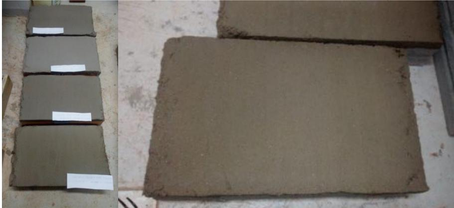
Passados 27 dias, deve-se realizar a colagem de 10 pastilhas metálicas no revestimento utilizando adesivo a base de epóxi, com intervalo de secagem de pelo menos 24 horas antes da realização do ensaio.
