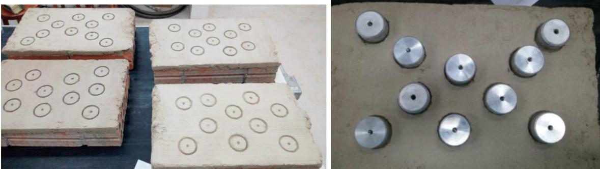
Os modelos serão ensaiados com 28 dias de idade, onde será aplicada uma força em uma velocidade de 250 N/s com o aparelho de arrancamento automático da SOLOTEST. Após o arrancamento foram medidos os diâmetros dos corpos de prova resultantes. Como a face de rompimento dos corpos de prova não apresentaram
