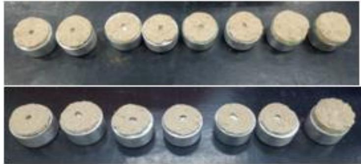
Para os corpos de prova com plano de falha similar ao apresentado na Figura 29, foram tiradas medidas dos 2 diâmetros perpendiculares externos e de diâmetro do furo onde se encontra o vazio em decorrência da perfuração do emboço pela guia da serra copo. Já para os corpos de prova com plano de falha similar ao apresentado na Figura 30, foram tomadas as medidas de 2 diâmetros perpendiculares.
