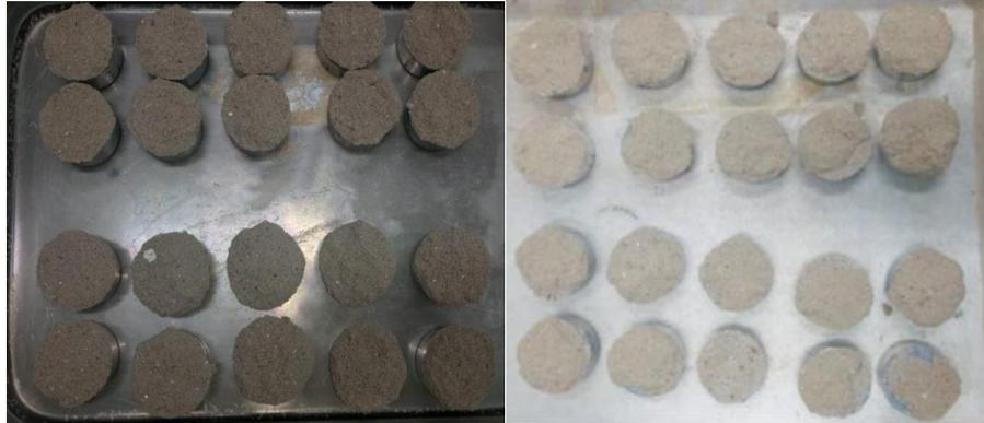
Figura 45 – Plano de falha em CPs de traços de cal e blenda
