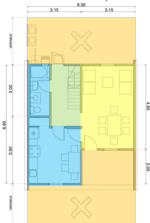
Figura nº 73. Análise da função na planta térrea com a ampliação realizada, sendo em amarelo a área social, em azul a área úmida, em verde área de circulação e em laranja área exterior.
