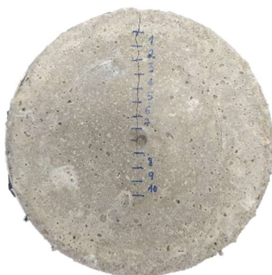
Figura 26: Amostra fissurada com abertura particionada em trechos de comprimento 5 mm
