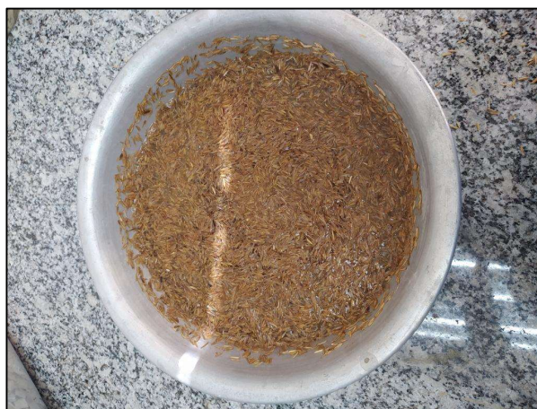
Figura 22: Recipiente contendo: casca de arroz in natura , solução bacteriana e nutrientes EL e LC, após 1 hora de imersão em água.
