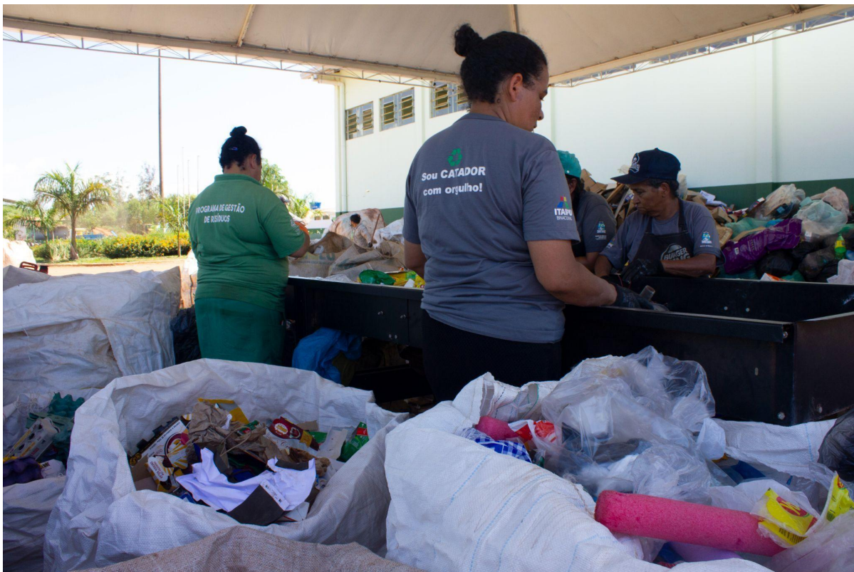
Foto- Mesa de separação de resíduos - Registro do Autor- Dezembro de 2022
