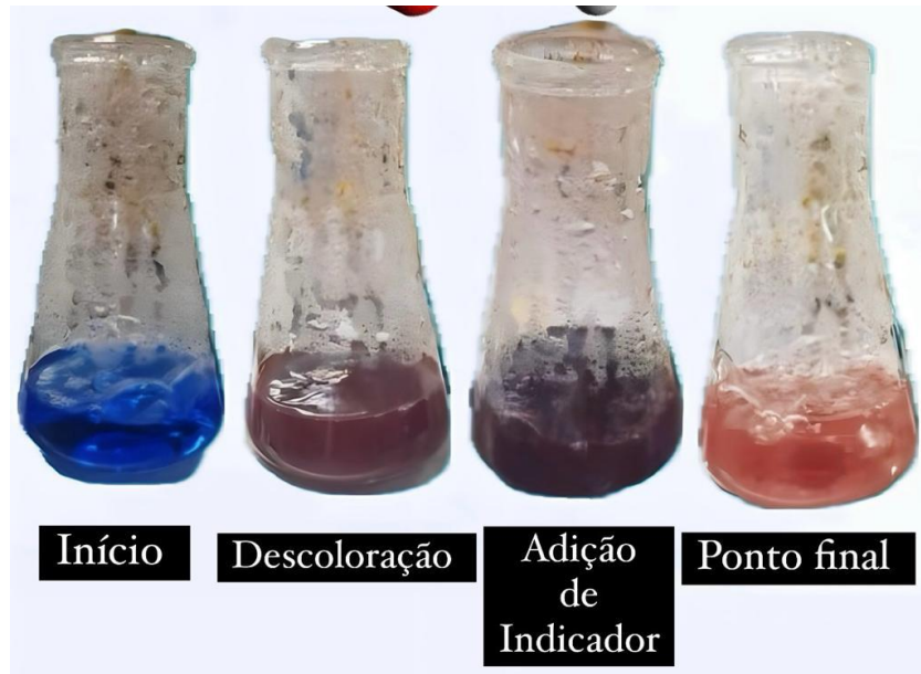
Figura 10 – Fotografia da amostra durante a titulação pelo método Lane-Eynon
