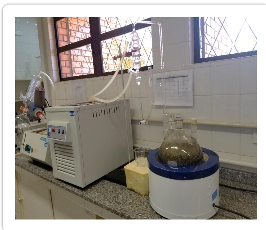
Imagen 20. Equipo utilizado para la extracción del aceite esencial de G. americana L.
