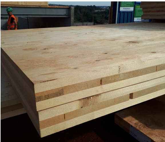
Figura 3.20. Painéis CLT com 3 lamelas
