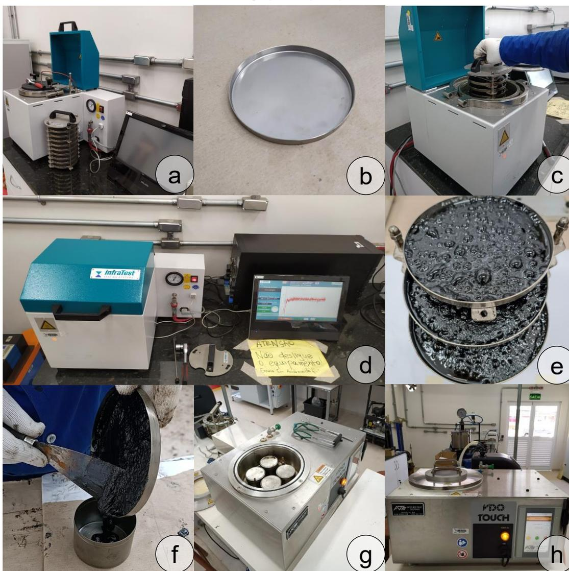
a) Equipamento PAV; b) Bandeja de ensaio; c) Posicionamento da estante com as bandejas no equipamento; d) Execução do ensaio; e) Estado do ligante após envelhecimento; f) Transferência para outro recipiente; g) Amostras prontas para remoção das bolhas de ar; h) Aplicação de vácuo.
