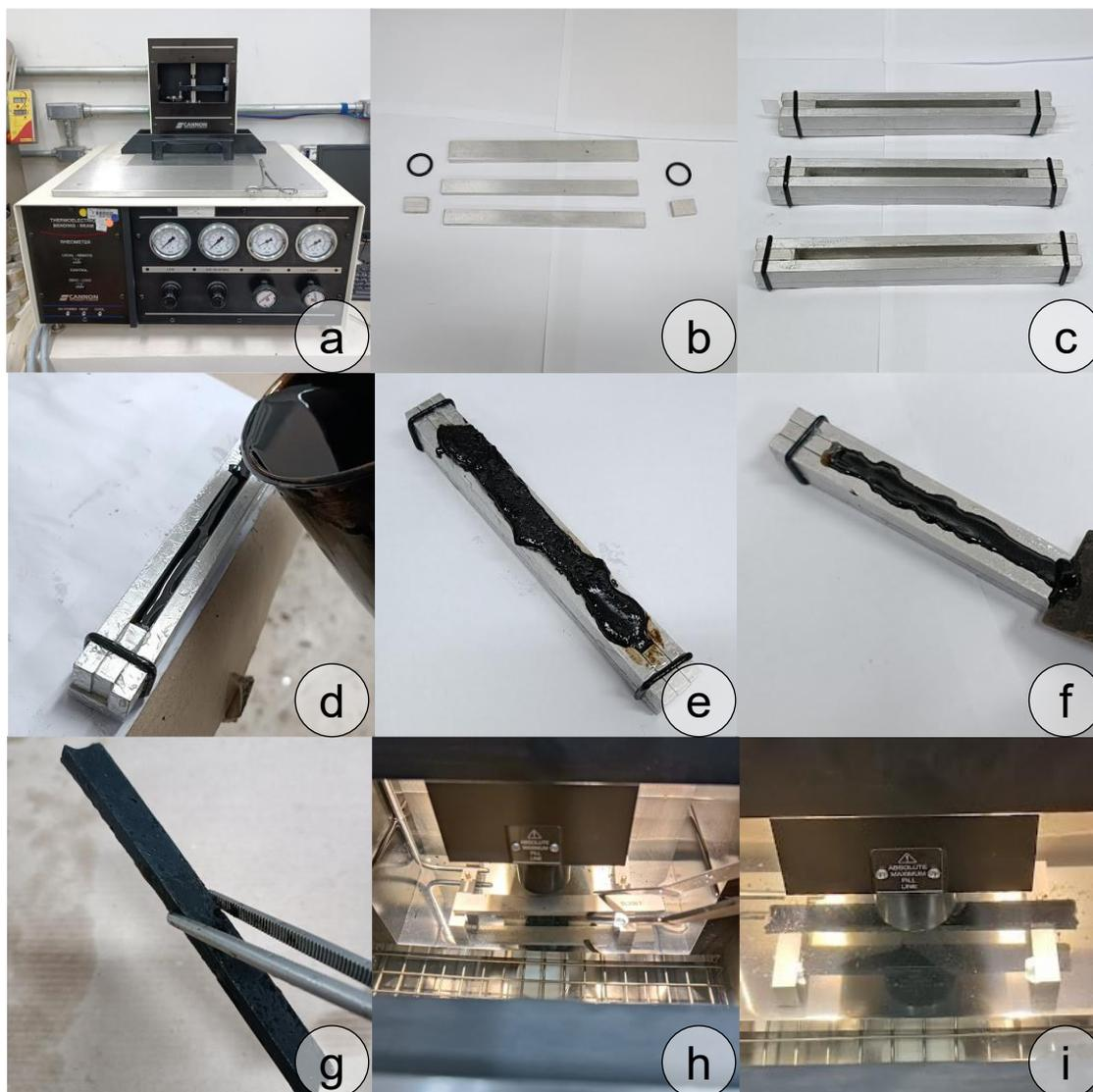
a) Reômetro de fluência em viga; b) Componentes dos moldes metálicos; c) Moldes das vigas montados; d) Preenchimento do molde com asfalto; e) Resfriamento em temperatura ambiente; f) Raspagem do excesso para posterior imersão em banho resfriado; g) Viga de ligante após desmolde; h) Calibração do equipamento; i) Execução do ensaio.
