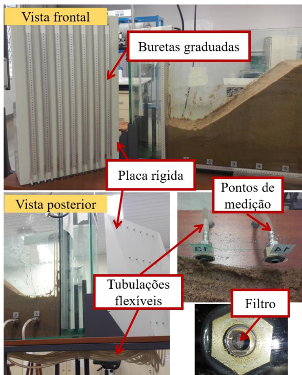
Figura 2. Esquema do sistema de medições piezométricas.
