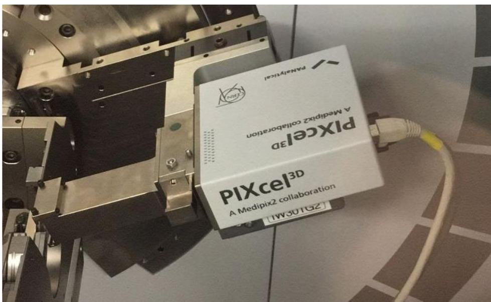
Figura 31: Detector de contagem de fótons PIXcel 3D.
