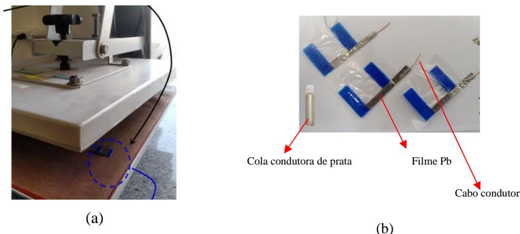
Figura 25: Montagem da célula retangular tipo U. a) Prensa térmico para selar a célula. b) Célula montada e pronta para colocar no difratômetro.
