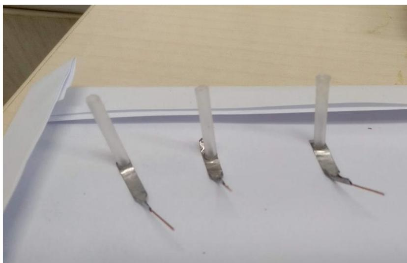
Figura 22: Células cilíndricas com diâmetro externo de 2.7 mm preparadas sem eletrólito.
