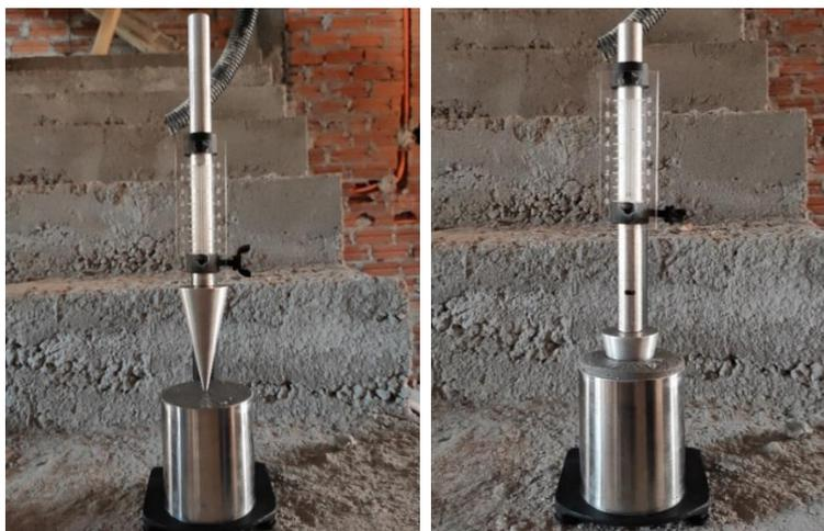
Para realizar a determinação do teor de ar incorporado nas argamassas o ensaio baseado na NBR NM 47 (ABNT, 2002), foi executado assim que o processo de mistura da argamassa foi paralisado. O aparelho utilizado foi da marca SOLOTEST, com capacidade de 8 litros conforme apresentado na Figura 2.10.
