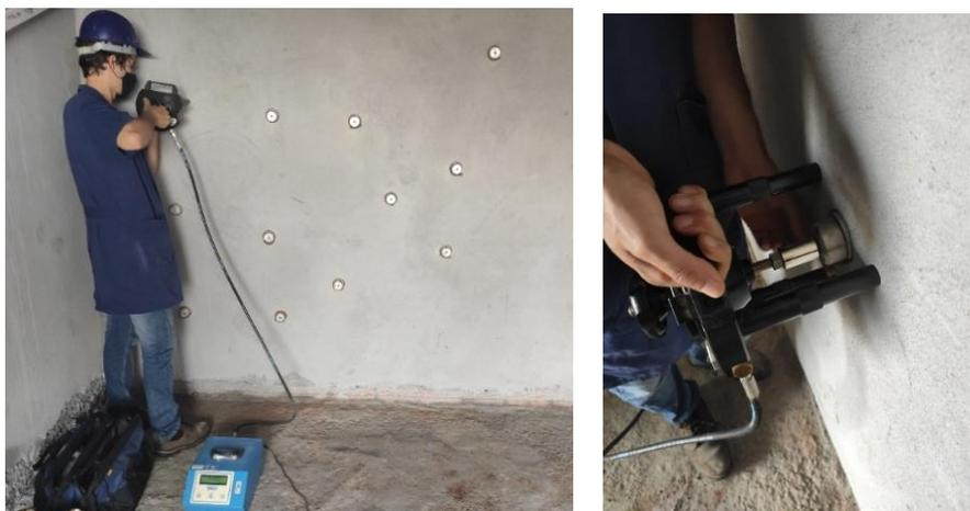
Na data anterior ao ensaio, foram feitos 12 cortes aleatórios no revestimento com dispositivo de corte seco de seção circular com diâmetro de 50 mm. Uma vez realizada a limpeza da superfície foi realizada a colagem das pastilhas do ensaio sobre os cortes com cola epóxi. Foram introduzidos nos cortes tiras de papelão para suporte das pastilhas durante a secagem da cola. Para o ensaio, foi utilizado aparelho da marca SOLOTEST com taxa de carregamento constante.
