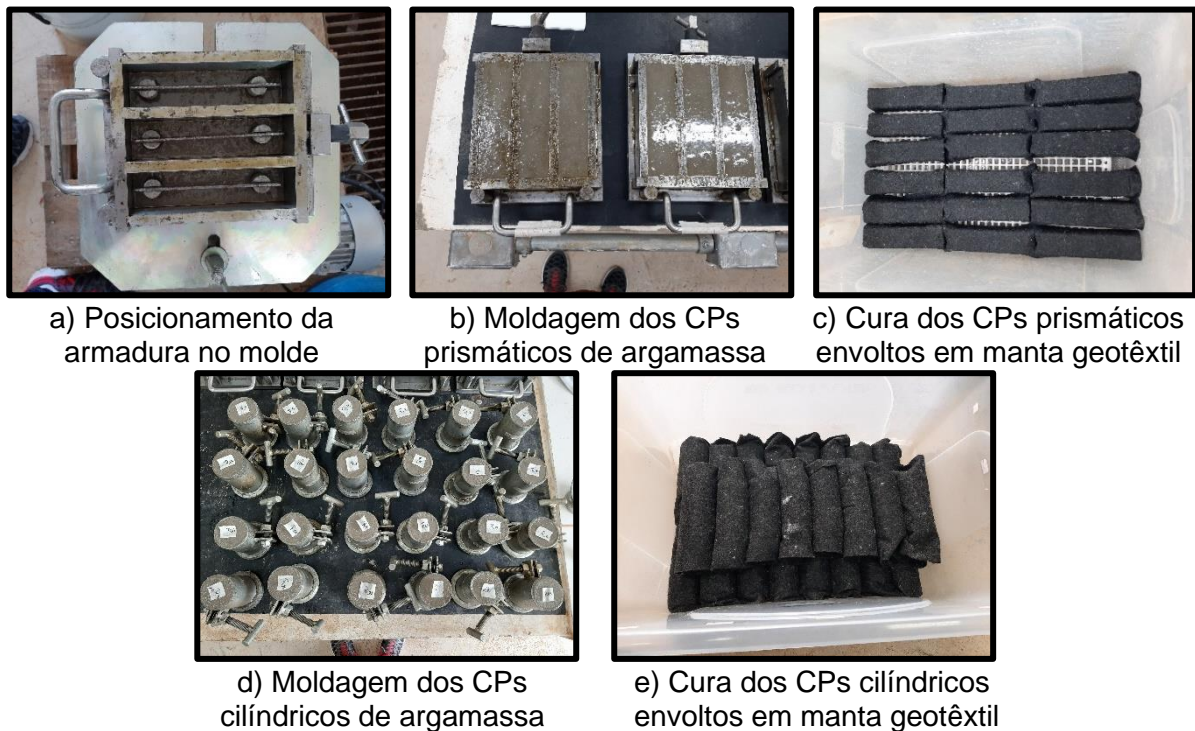
Figura 9 – Produção e cura das amostras de argamassa
