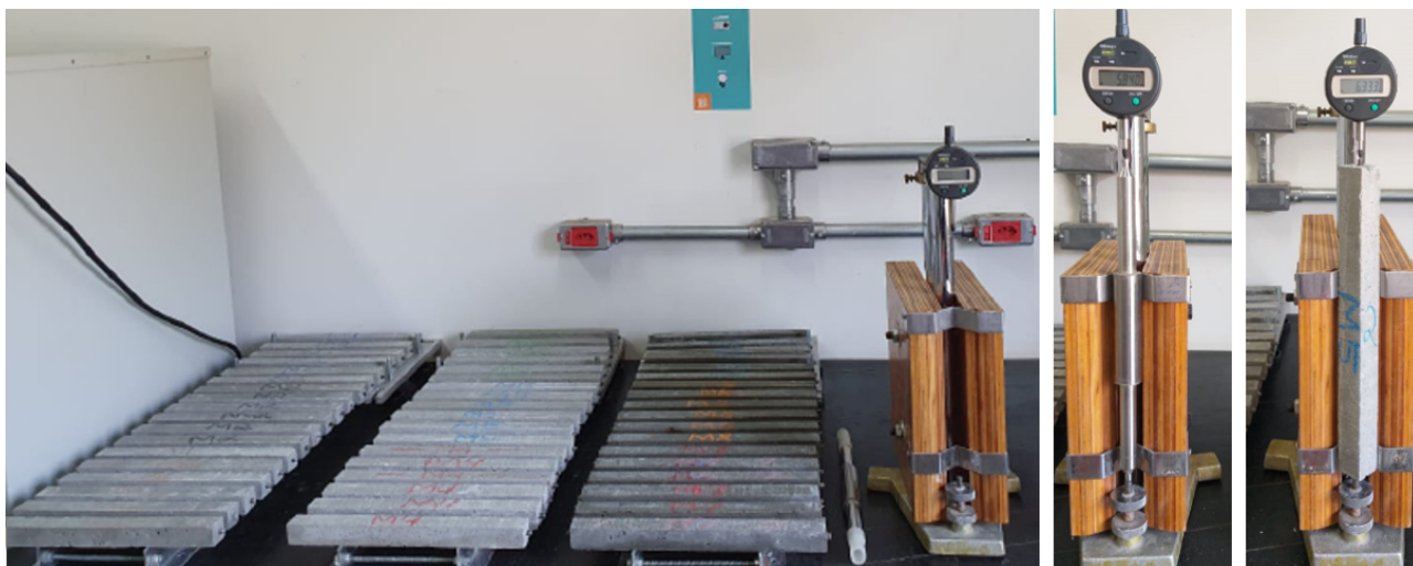
Figura 18 – Aparato com relógio comparador e os corpos de prova do ensaio.
