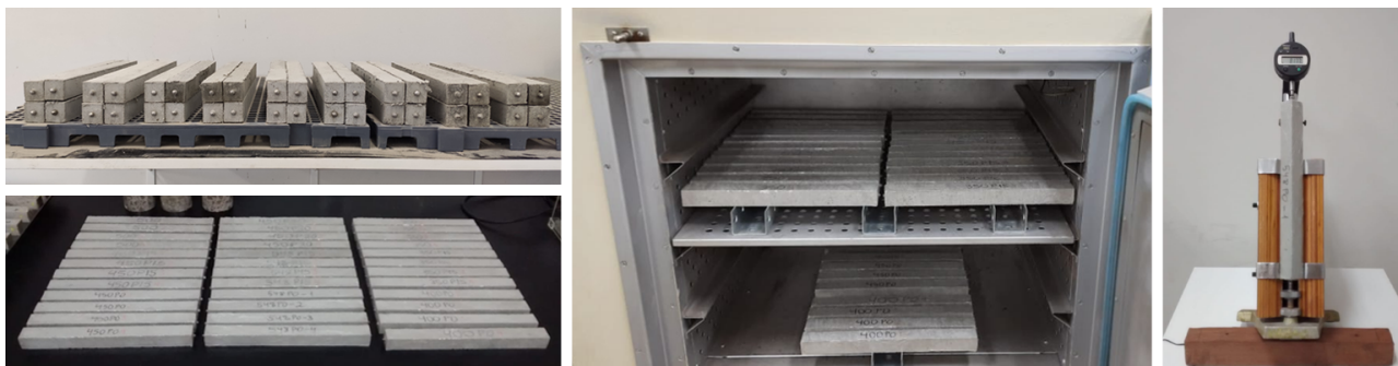
Figura 17 – Procedimentos empregados no ensaio de coeficiente de dilatação térmica linear.
