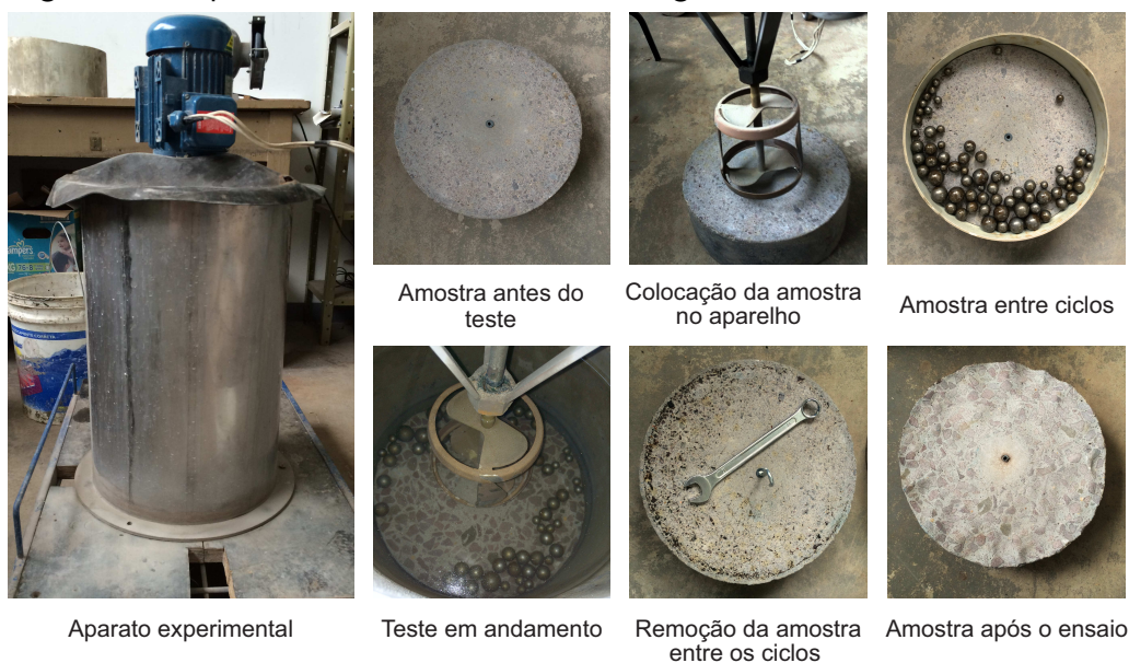
Figura 19 – Aparato de abrasão hidráulica e algumas fases do ensaio abrasivo.
