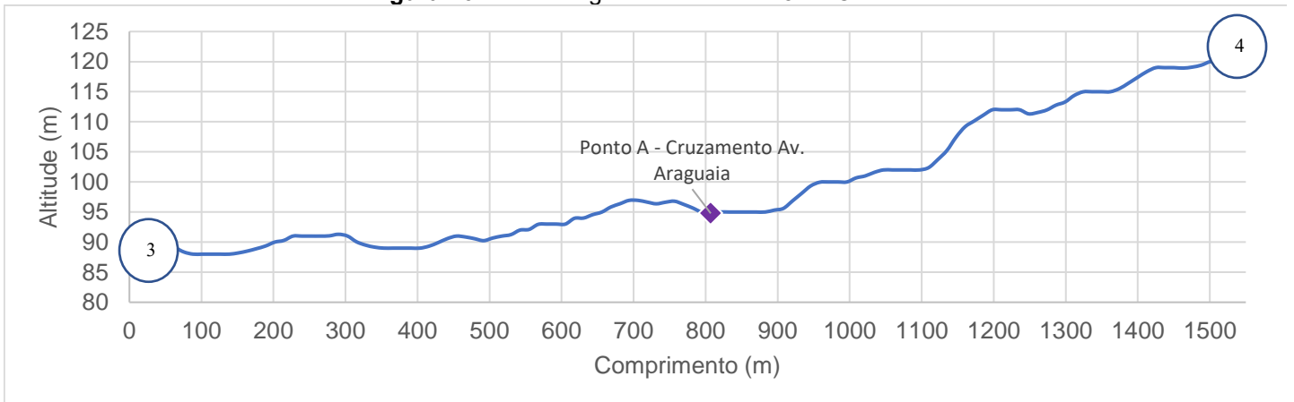
Figura 26. Perfil Longitudinal da Rua 13 de Outubro
