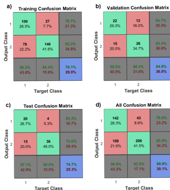
Figura 40: Matrizes de Confusão da Rede Neural para o LPQ com 40 neurônios na camada oculta e duas saídas.
