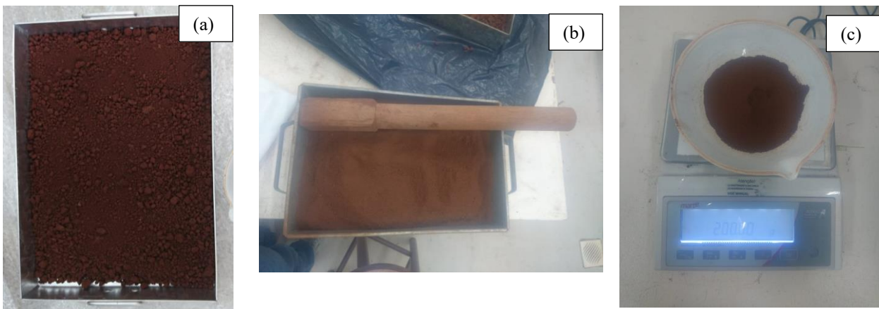
Figura 10 – Ensayo de granulometría. (a) Secado de la muestra de suelo. (b) Disgregación de los terrones del suelo. (c) Muestra representativa para realizar el ensayo.
