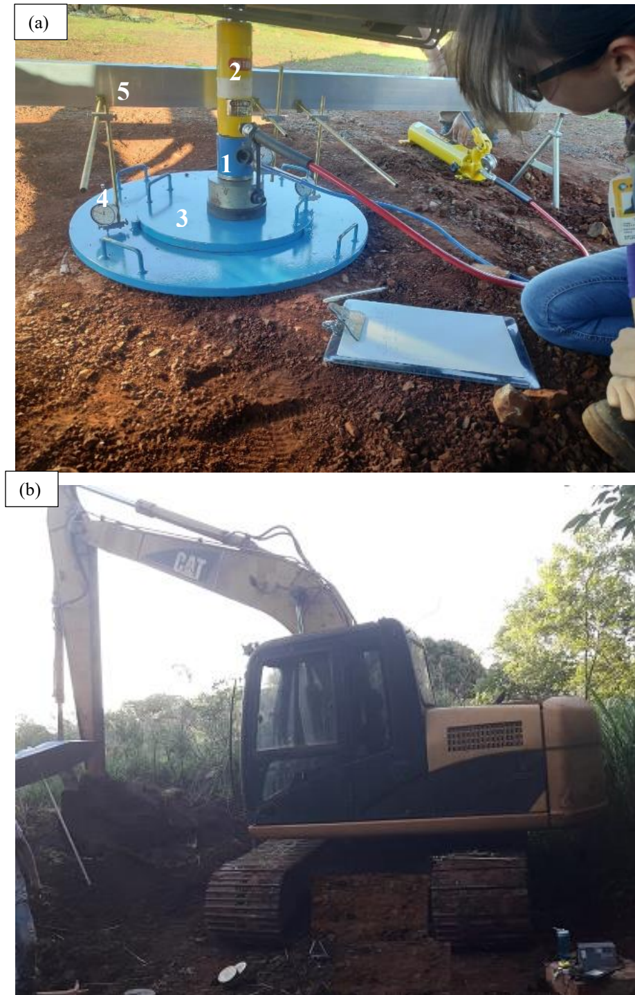
Figura 9 – Equipo para el ensayo de prueba de carga. a: Instrumentación (1) Célula de carga (2) Gato hidráulico (3) Placa de 50 cm de diámetro (4) Relojes comparadores (5) Viga, b: Tractor de orugas
