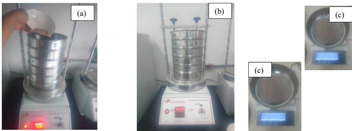
Figura 12 – Ensayo de granulometría por tamizado. (a) Colocación de la muestra lavada al conjunto de tamices. (b) Proceso de vibración de tamices con la muestra de suelo. (c) Pesaje de las partículas retenidas en cada tamiz
