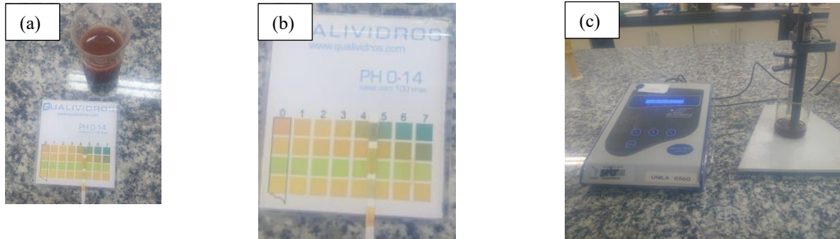
Figura 13 – Medición del pH del suelo. (a) Medición del pH, por medio del papel indicador. (b) Lectura del pH del suelo (ácida). (c) Medición del pH por medio del pHmetro.
