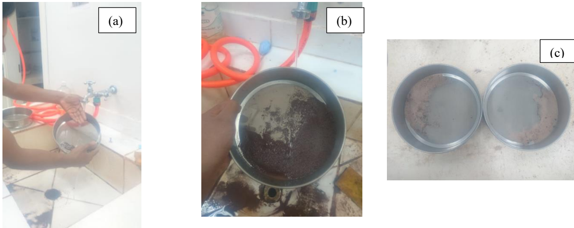
Figura 11 – Ensayo de granulometría proceso tamizado. (a) y (b) Lavado del suelo en el tamiz N° 200. (c) Secado en estufa del material lavado.
