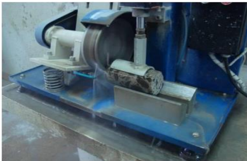
Figura 31 - Retificação do corpo de prova Fonte: Autor (2020)
