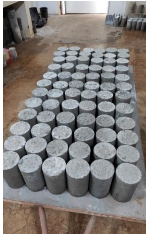
Figura 30 - Corpos de prova de concreto no estado endurecido Fonte: Autor (2020)
