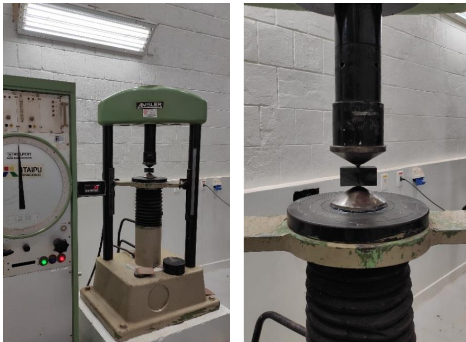
Figura 25 - Equipamento e ponteiros cônicos no ensaio de índice de carga pontual
