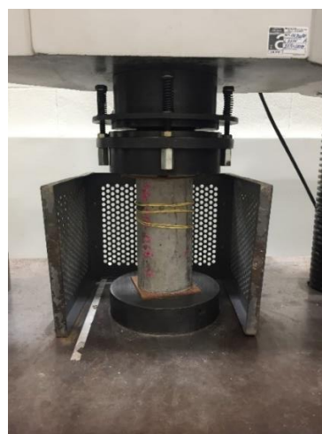
Figura 33 - Equipamento e ensaio de resistência à compressão axial Fonte: Autor (2020)
