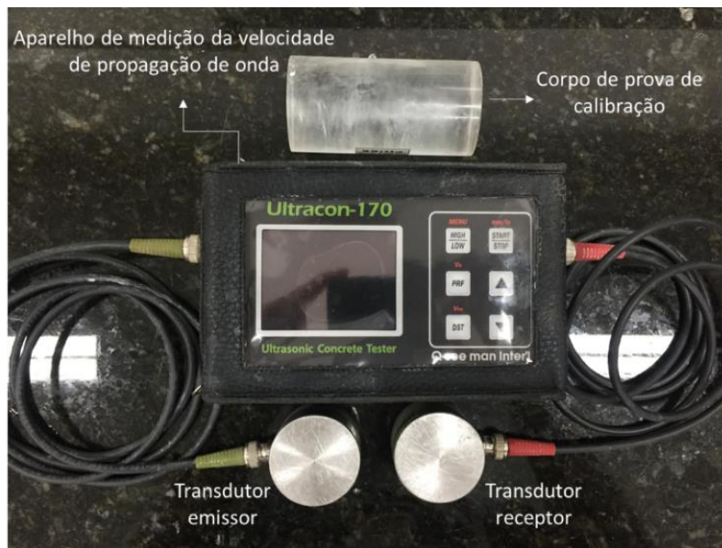
Figura 36 - Equipamento Ultracon-170 para medição do E_d pelo método de Velocidade de Pulso Ultrassônico
