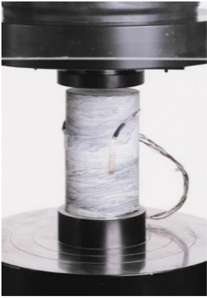
Figura 6 - Medidor elétrico do tipo strain gage
