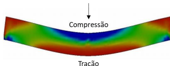
Figura 9 - Solicitação de esforços em um corpo de prova hipotético no ensaio de flexão Fonte: Pereira e Otani (2017)
