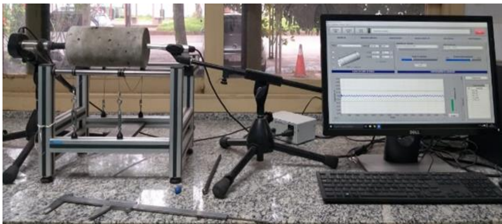
Figura 35 - Ensaio do módulo de elasticidade dinâmico pela Técnica de Excitação por Impulso
