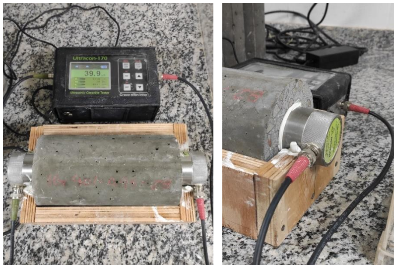
Figura 38 - Arranjo do corpo de prova de concreto no suporte para a medição do E_{d,VPU}
