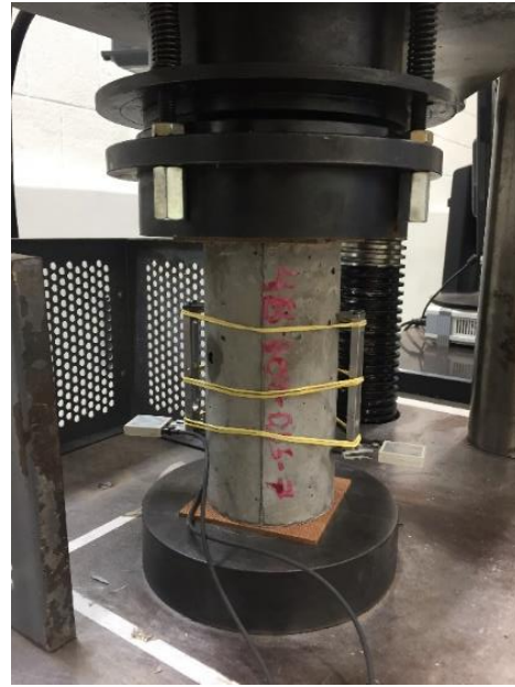
Figura 7 - Medidor elétrico do tipo clip gage
