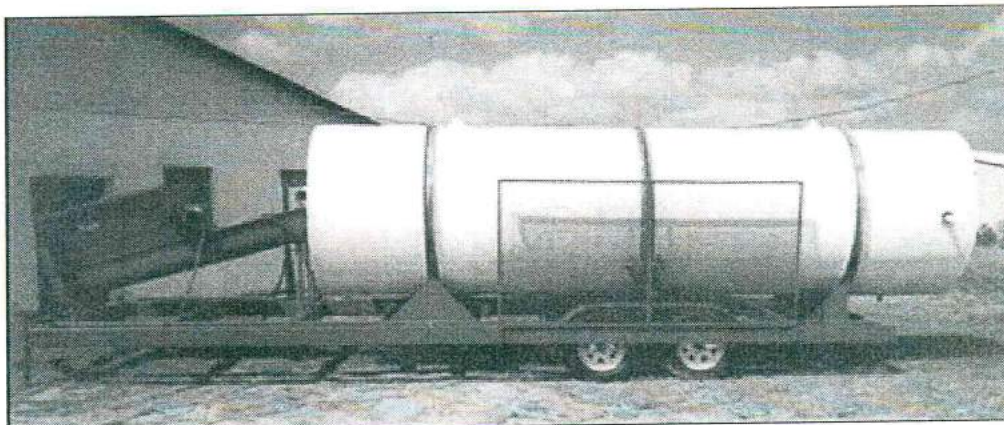
Figura 7 – Reator “In-vessel” formato cilíndrico.
