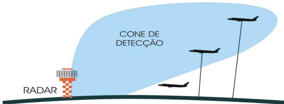
Figura 6: Simulação de como funciona os radares
