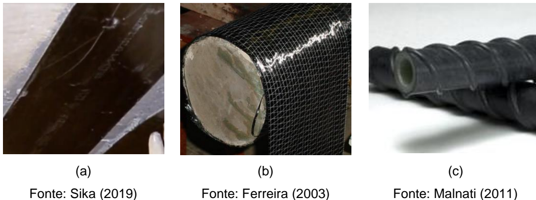
Figura 2-3 - Tipos de fibras de carbono: (a) Laminado, (b) Manta e (c) Barra
