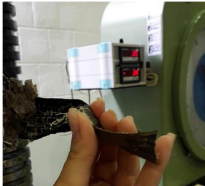
Figura 5-47 - CFRP flexível durante ensaio – Pilar C20_1_s_1_40_720
