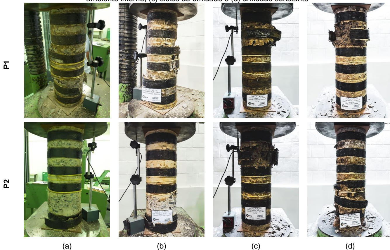
Figura 5-46 - Pilares com confinamento discreto com 1 camada após ruptura (a) referência, (b) ambiente interno, (c) ciclos de umidade e (d) umidade constante
