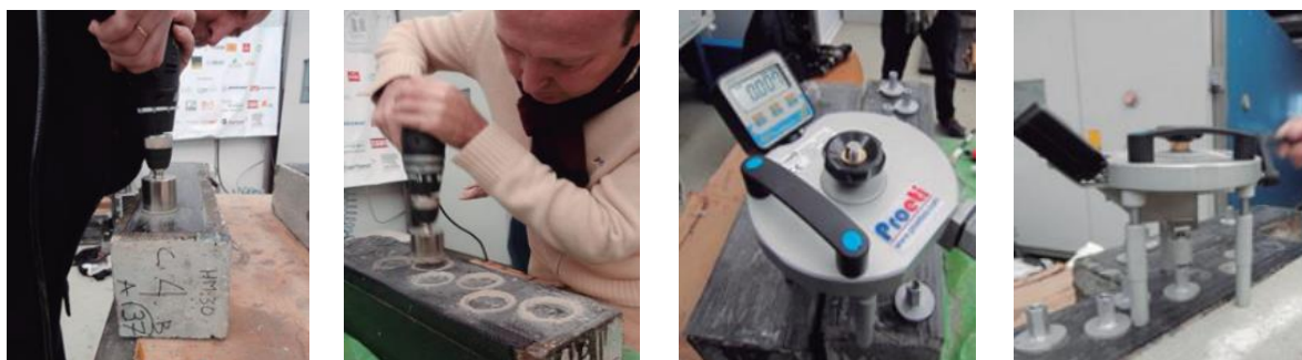
Figura 2-11 - Processo de ensaio pull-off : (a) Corte circular sobre o compósito (b) Corte circular em diferentes regiões da face do prisma (c) Equipamento para realização do ensaio (d) Execução do ensaio pull-off
