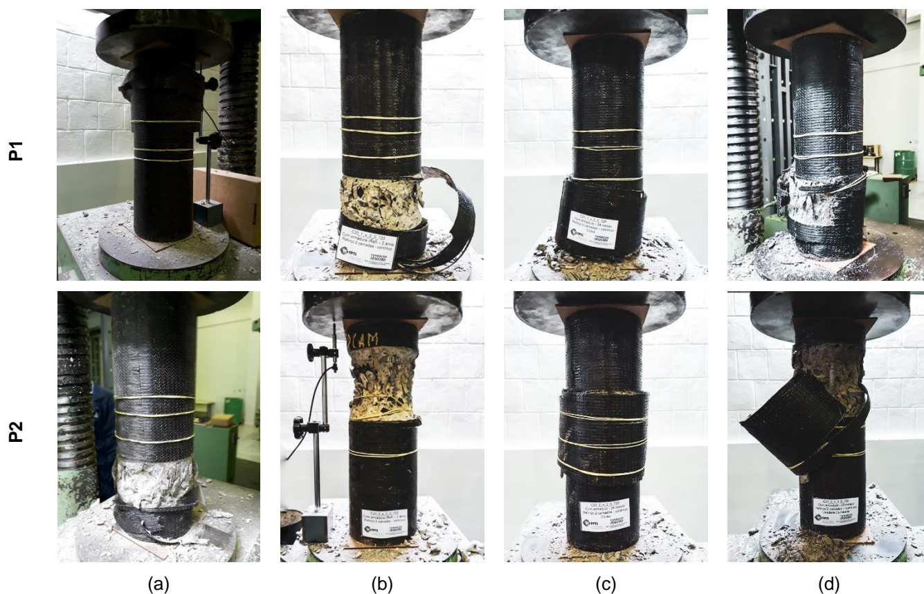
Figura 5-74 - Pilares com confinamento contínuo com 2 camadas após ruptura (a) referência, (b) ambiente interno, (c) ciclos de umidade e (d) umidade constante
