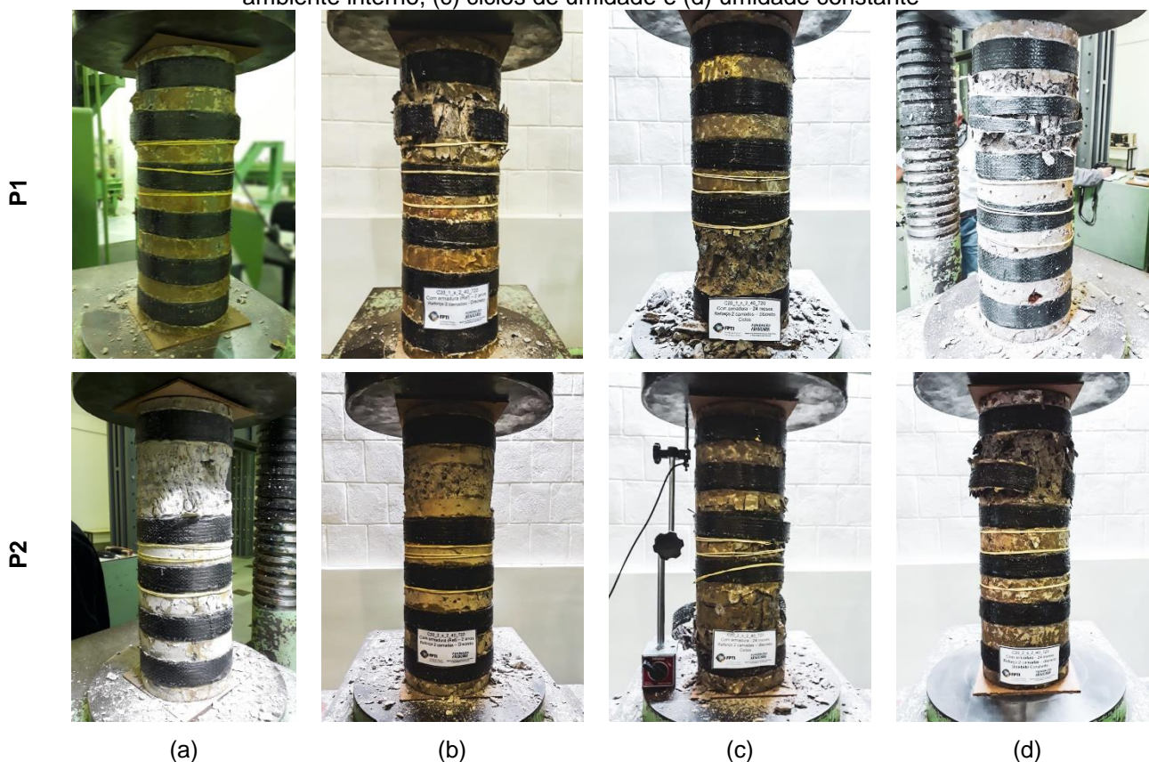
Figura 5-56 - Pilares com confinamento discreto com 2 camadas após ruptura (a) referência, (b) ambiente interno, (c) ciclos de umidade e (d) umidade constante
