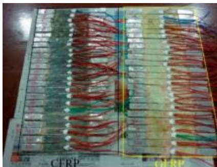
Figura 3-3 - Corpos de prova de CFRP e GFRP de Liang et al. (2018)
