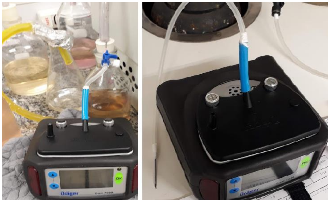
Figura 13: Análise do biogás (à esquerda) e detector portátil de gases (à direita).
