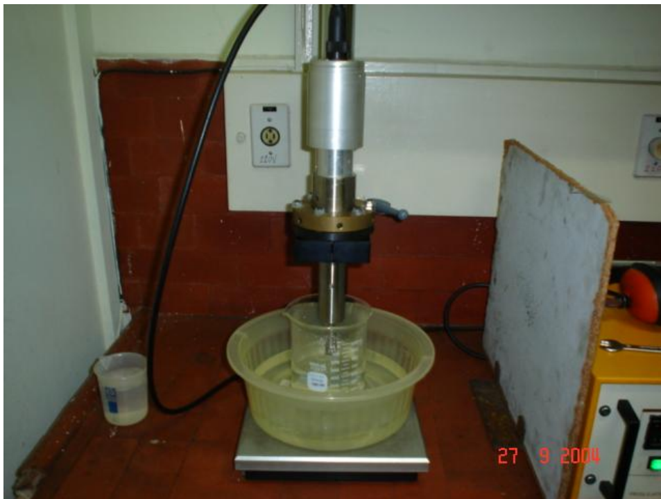
Figura 4.7 - Equipamento Telsonic com a montagem para o teste de erosão cavitação vibratória.
