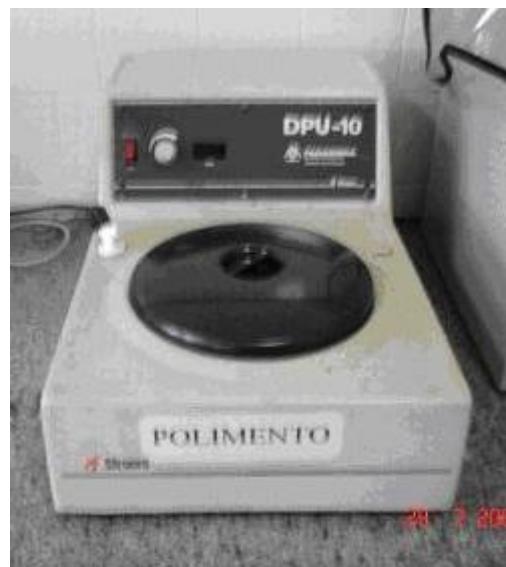
Figura 4.2 - Struers DPU-10, equipamento utilizado para lixar e polir.
