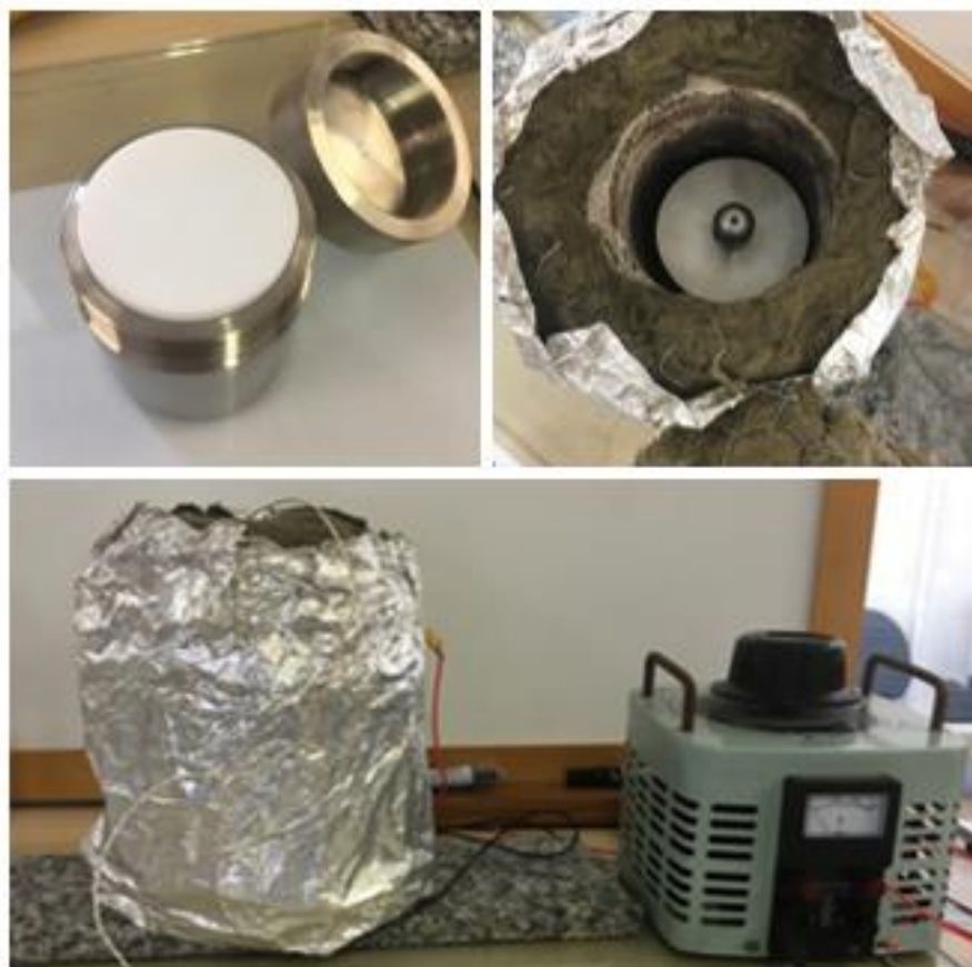
Figura 4.20. Reator e forno utilizado durante o tratamento hidrotérmico para a obtenção dos nanocompósitos.
