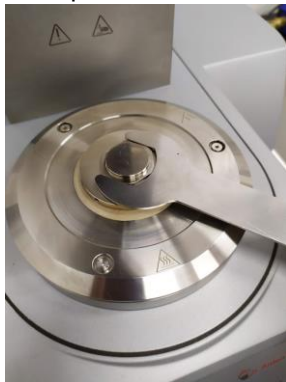
Figura 55. Montagem da placa inferior
