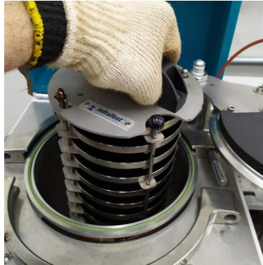
Figura 73. Posicionamento dentro do PAV
