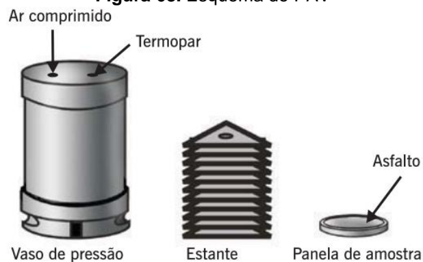
Figura 68. Esquema do PAV
