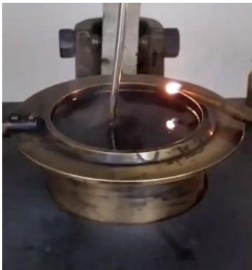
Figura 37. Passagem da chama de ensaio
