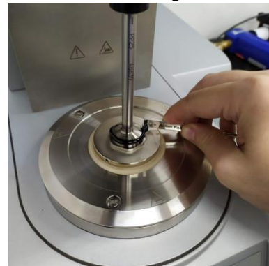
Figura 60. Remoção do excesso de ligante
