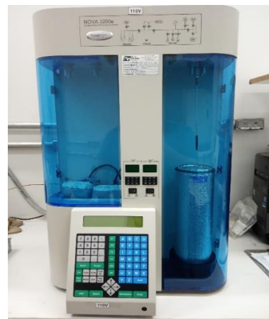
Figura 14: Equipamento utilizado para o ensaio de área específica BET
