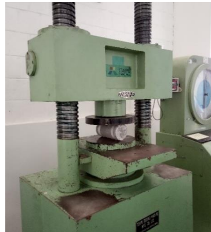
Figura 21: Prensa hidráulica da marca TORSEE, usada para realização de ensaios à compressão axial e tração por compressão diametral
