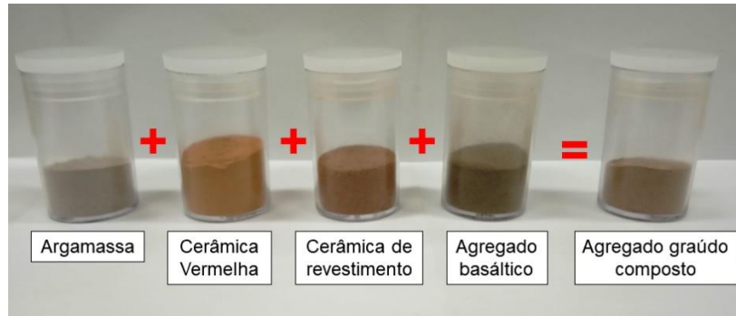
Figura 16: Compostos moídos e composição do agregado graúdo reciclado moído
