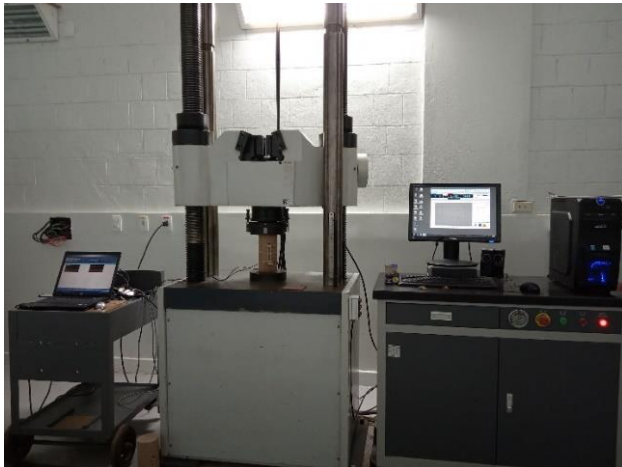
Figura 20: Prensa hidráulica da marca TIME, usada para realização de ensaios de compressão axial e módulo de elasticidade estático
