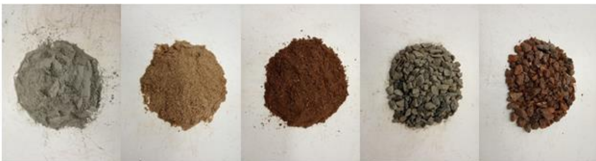
Figura 12: (a) cimento; (b) agregado miúdo natural; (c) agregado miúdo reciclado; (d) agregado graúdo natural; (e) agregado graúdo reciclado.
