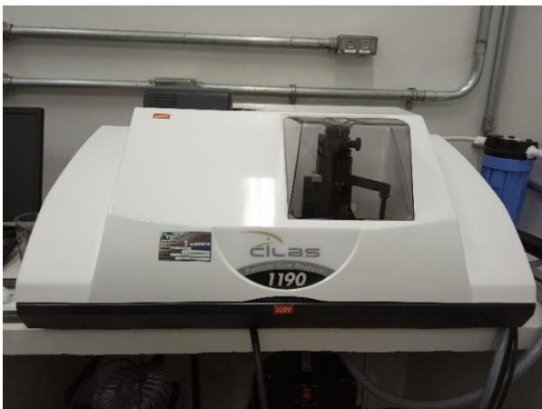
Figura 13: Equipamento utilizado para o ensaio de granulometria a laser
