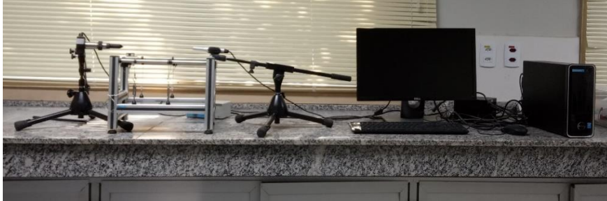
Figura 19: Equipamento SONELASTIC, utilizado para a realização do módulo de elasticidade dinâmico 5
