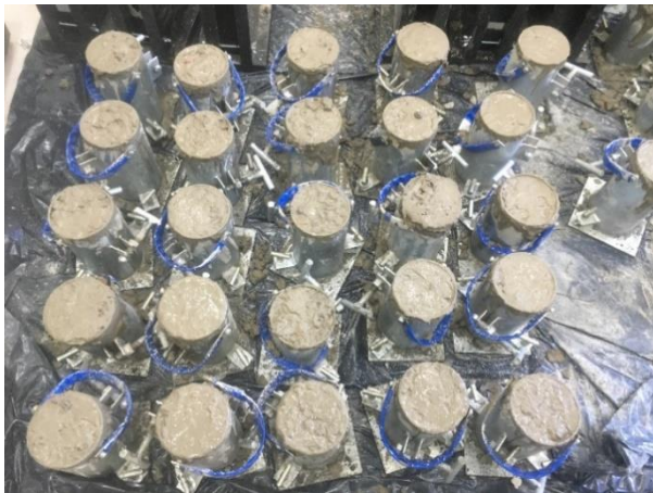
Figura 17: Corpos de prova após a concretagem
