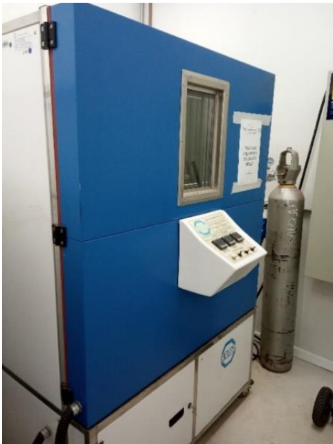
Figura 22: Câmara climatizada utilizada para os ensaios de carbonatação
