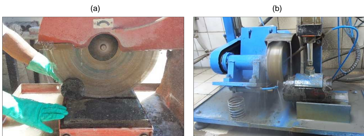
Figura 29 – Preparação dos corpos de prova: (a) corte em serra; (b) retífica de faces.
