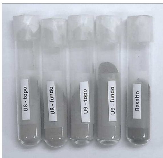
Figura 31 – Amostras em pó para ensaios DRX e TG.
