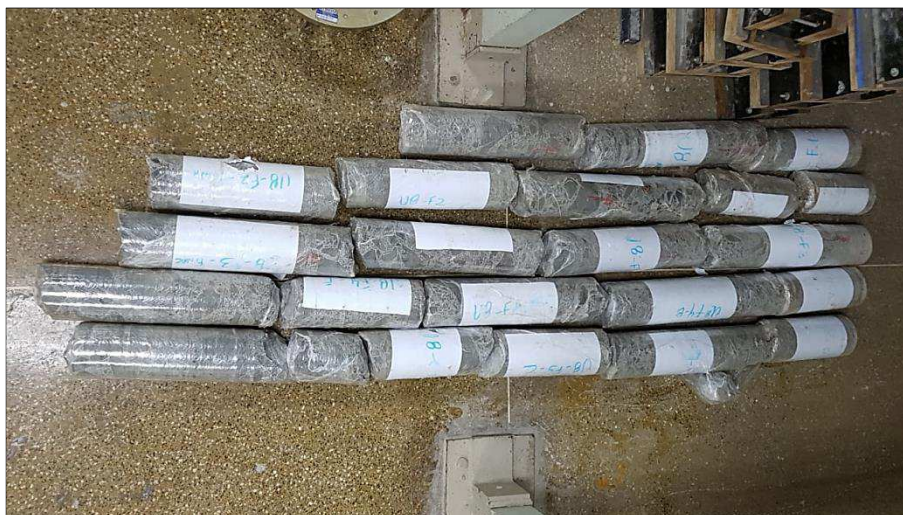
Figura 28 – Testemunhos de concreto identificados e envelopados.
