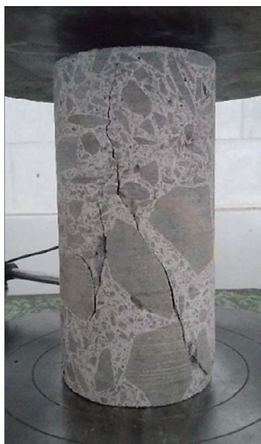
Figura 49 – Corpo de prova submetido a ensaio de compressão.
