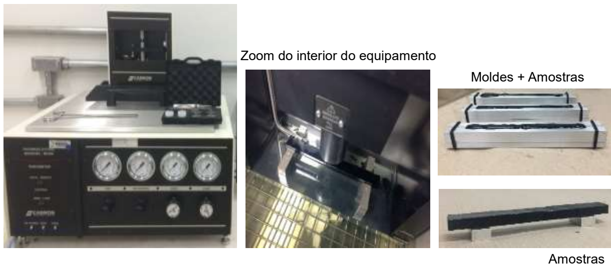
Figura 16 – Detalhamento do ensaio utilizando o Reômetro de Fluência em Viga (BBR).
