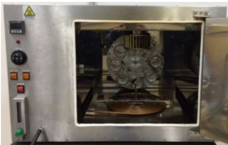
Figura 17 – Estufa de Filme Fino Rotativo (RTFOT).
