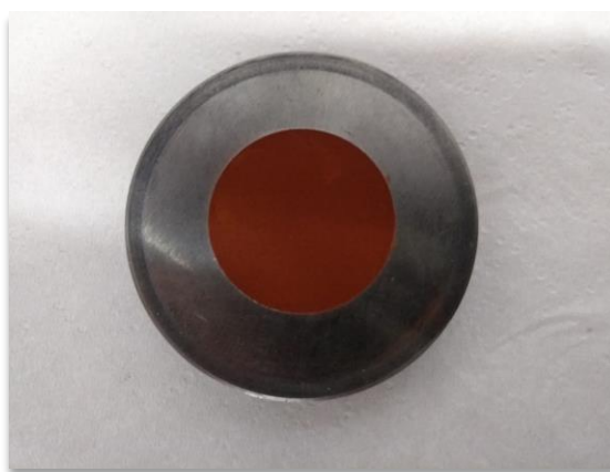
Figura 11. Porta amostra do DRX preparado com pó de Goetita moída durante 45 horas.
