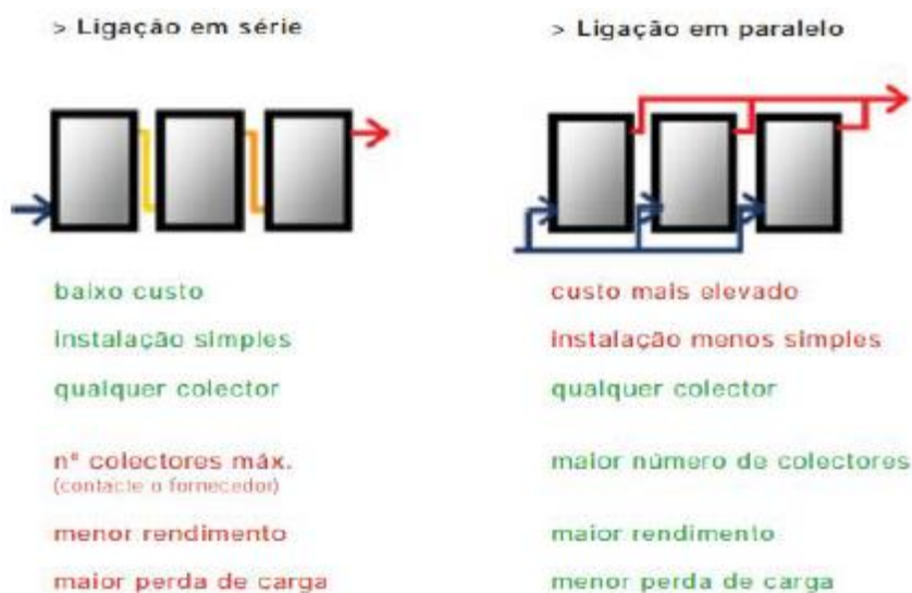
Figura 9: Esquema de ligação série – paralelo de coletores solares térmicos.
