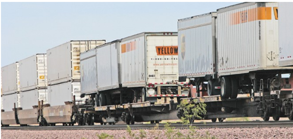
Figura 35 – Transporte de semirreboques (sistema piggyback).
