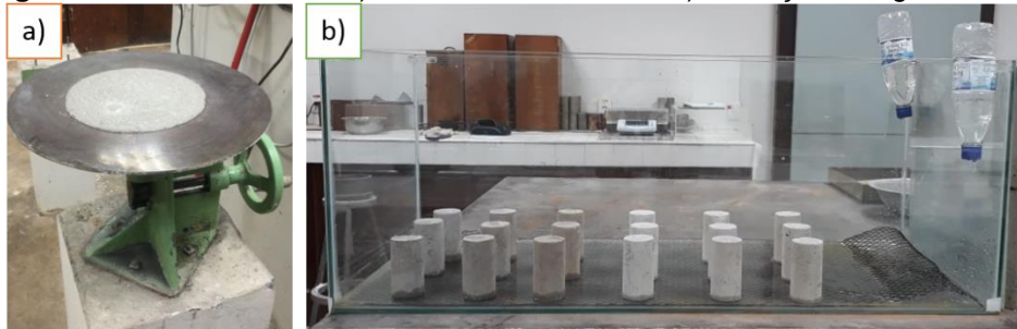
Figura 13. Ensaio físico: a) Índice de consistência b) Absorção de água
