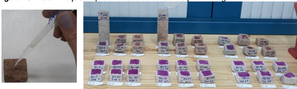
Figura 18. Determinação da profundidade de carbonatação das argamassas
