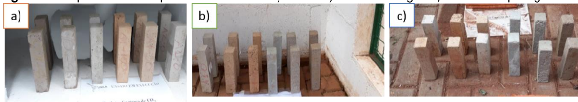
Figura 12. Corpos de Prova expostos em ambiente: a) Interno b) Externo Protegido c) Externo Desprotegido
