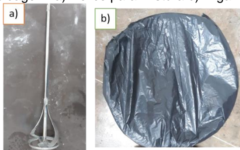
Figura 11. Detalhes da moldagem: a) Hélice para mistura b) Argamassa vedada em maturação
