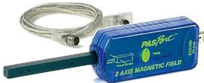
Figura 12: Punta de Hall para la determinación del campo. Fuente: https://tecnoedu.com/Pasco/Magnetismo.php#PS2112
