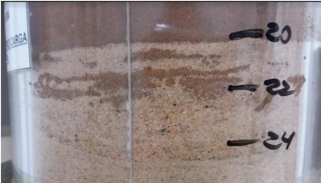
Figura 2. Ruptura da barreira capilar do RCD-miúdo/areia
