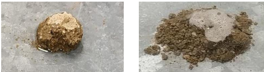
Figura 4. Antes (a) e depois (b) do ensaio de desagregação (amostra inalterada)
