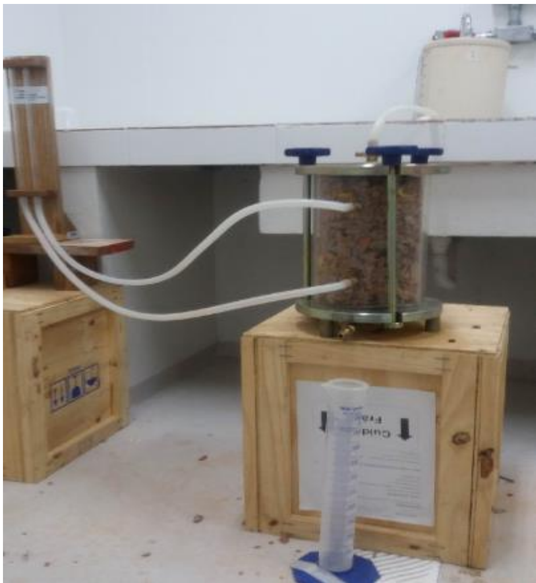
Figura 1. Permeâmetro de carga variável da sala climatizada do laboratório de mecânica de solos da UNILA.
