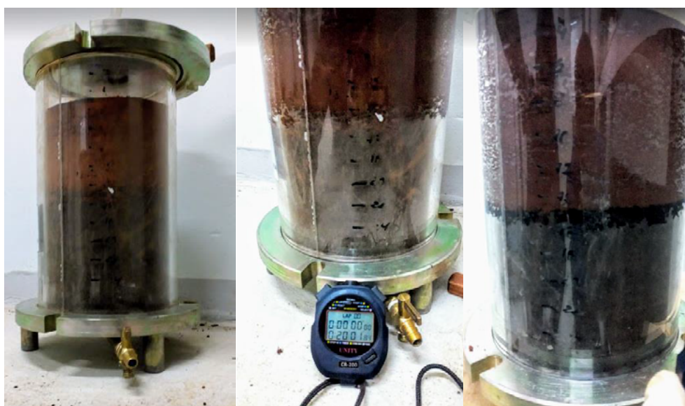
Figura – 3 Barreira capilar inicial (a), ruptura da barreira capilar CRSU-seco (b), e ruptura da barreira capilar CRSU-úmido
