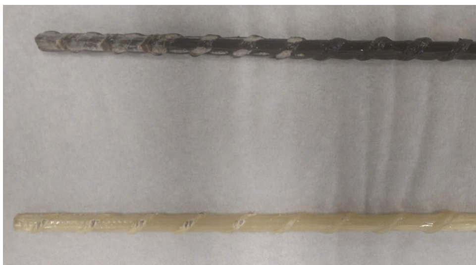
Figura 67 – Vergalhões de BFPR (parte superior) e GFPR (parte inferior) após ensaio de tração – Saliências dos vergalhões danificadas pelo escorregamento na região das garras da máquina universal de ensaios.
