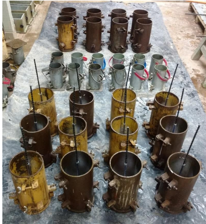
Figura 32 - Preparação dos moldes - Ensaio “ pull-out ” – Vergalhões de BFPR.
