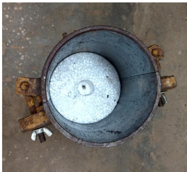
Figura 25 - Molde padrão com o anel de EPS colocado em sua base.
