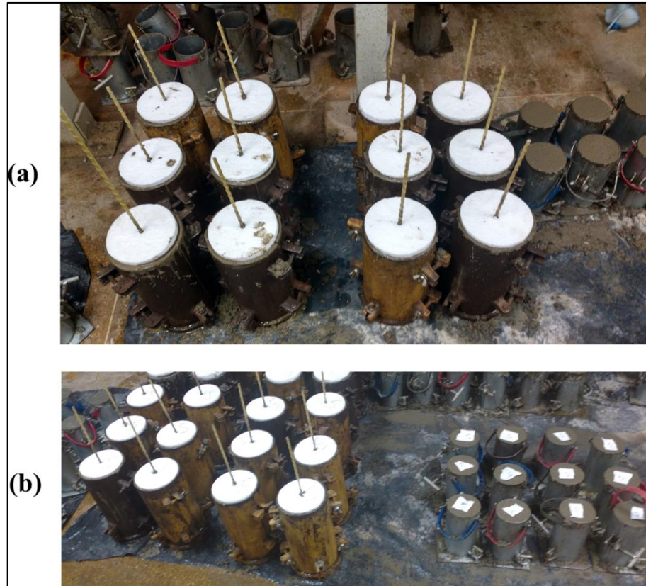
Figura 39 - Corpos de prova moldados - Vergalhões de GFPR. (a) concreto sem sal (b) concreto com sal.
