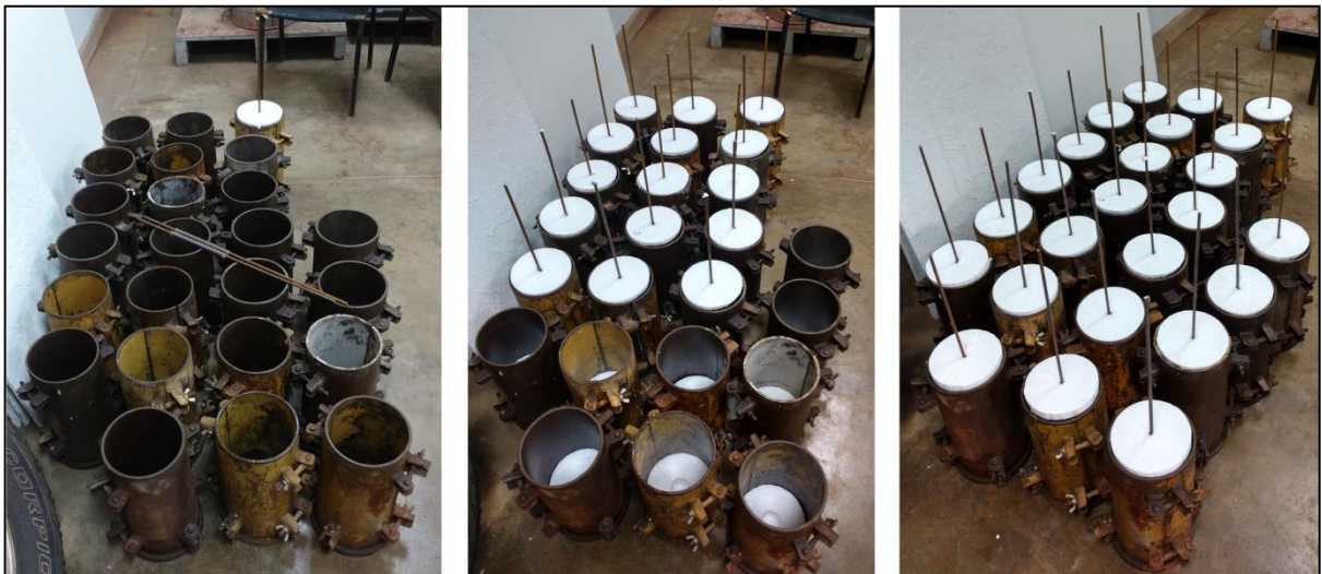
Figura 31 - Preparação dos moldes - Ensaio “ pull-out ” – Vergalhões de Aço CA-50.
