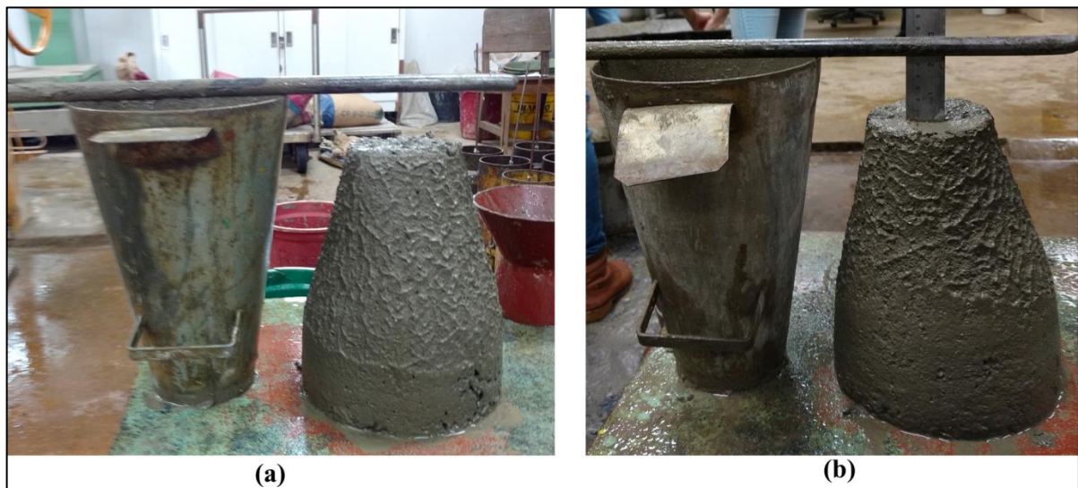
Figura 34 - Teste de abatimento do tronco de cone para o concreto utilizado no conjunto definitivo de corpos de prova para testes com ensaio “ pull-out ” com vergalhões de Aço CA-50. (a) Concreto sem sal. (b) Concreto com sal.
