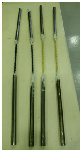
Figura 69 – Amostras de vergalhões de BFPR (esquerda) e GFPR (direita) preparadas para o ensaio de tração – Utilização de luvas de tubos metálicos preenchidos com resina epoxi.
