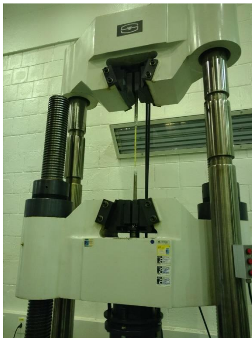
Figura 70 – Ensaio de tração do vergalhão de Aço CA-50 realizado na máquina universal de ensaios do LTC / Itaipu. Amostra de GFPR utilizando luvas de tubos metálicos preenchidos com resina epóxi.
