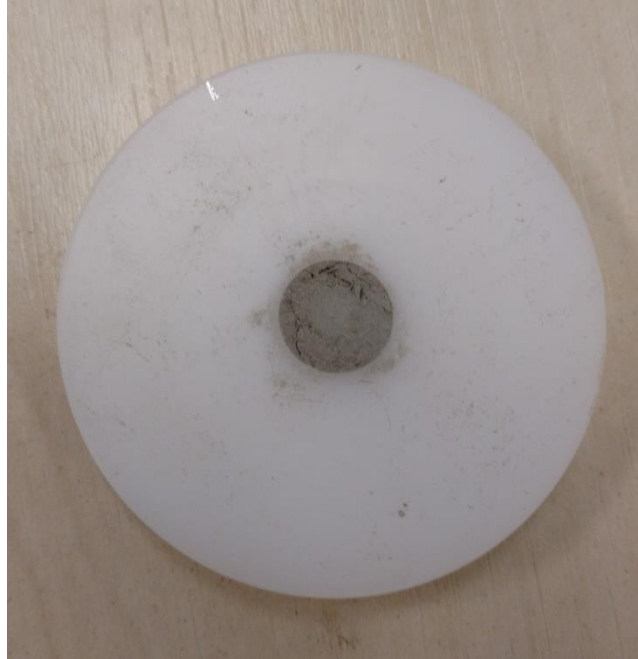
Figura 52 - Porta amostra em teflon, com a amostra, em pó, do vergalhão de BFPR.
