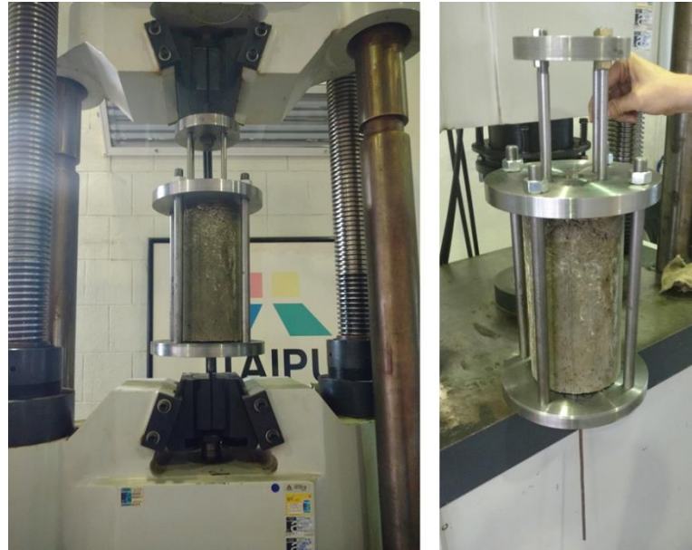
Figura 18 - Montagem experimental ensaio "pull-out" – Teste preliminar.
