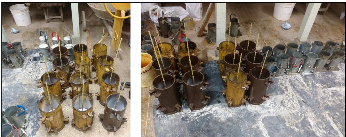
Figura 33 - Preparação dos moldes - Ensaio “ pull-out ” – Vergalhões de GFPR.
