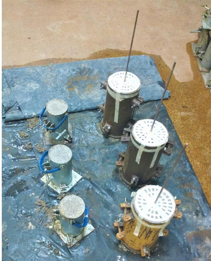
Figura 29 - Segundo conjunto de corpos de prova para testes com ensaio “ pull-out ” em fase final de moldagem.
