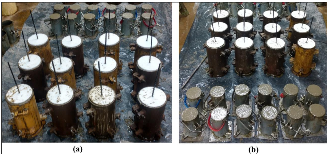
Figura 38 - Corpos de prova moldados - Vergalhões de BFPR. (a) concreto sem sal (b) concreto com sal.
