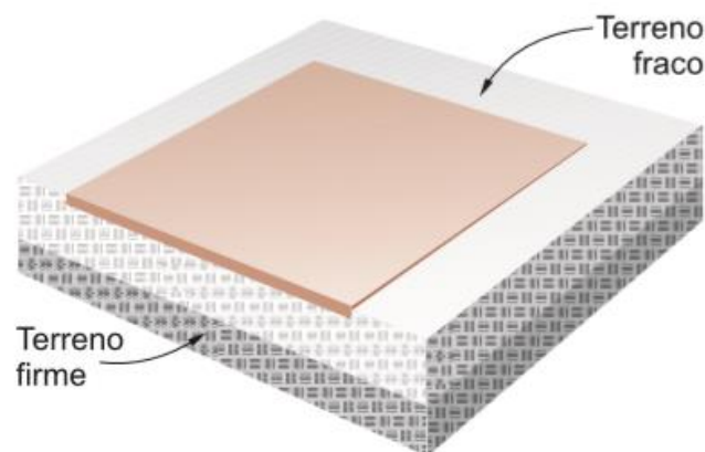
Figura 33. Losas de cimentación
