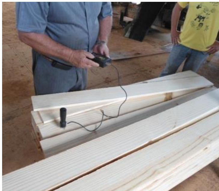
Figura 14. Control de humedad
