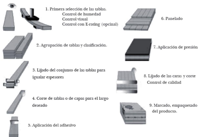
Figura 13. Fases de Producción de CLT
