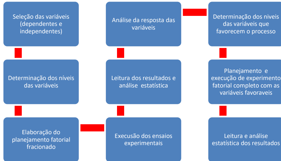
Figura 3. Esquema do planejamento fatorial fracionado e completo. Fonte: Adaptado de Da Silva & Neto, 2013.
