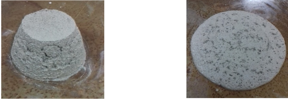
Figura 1 – Ensaio mesa de consistência realizado no Laboratório de Concreto de Itaipu. (Fonte: Autora)
