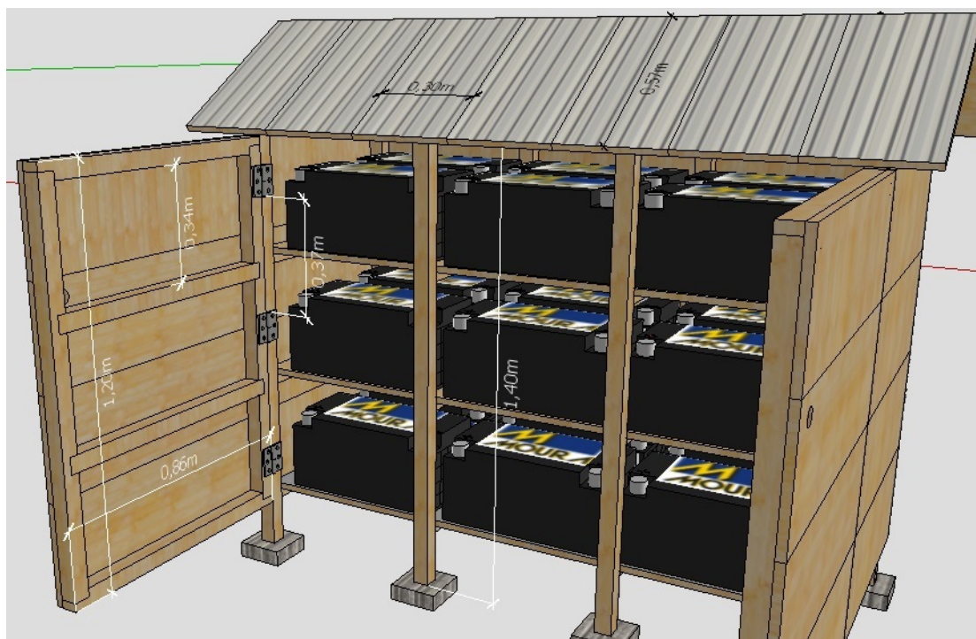
Figura 40 – Casa de proteção para o banco de baterias - vista 1
