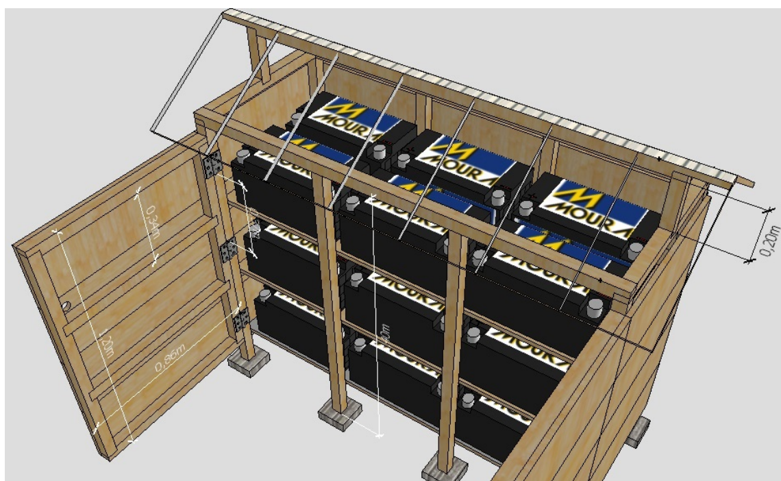
Figura 41 – Casa de proteção para o banco de baterias - vista 2
