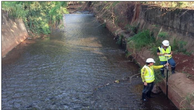
Figura 57: Medição dos pontos da seção mediante o Rover e a Coletora
