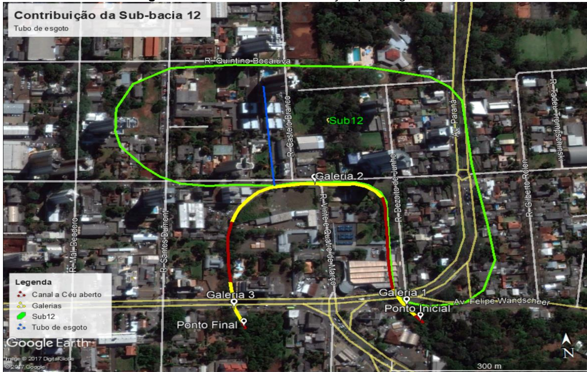
Figura 42: Sub-bacia de contribuição para a galeria 2
