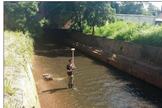
Figura 57: Medição dos pontos da seção mediante o Rover e a Coletora
