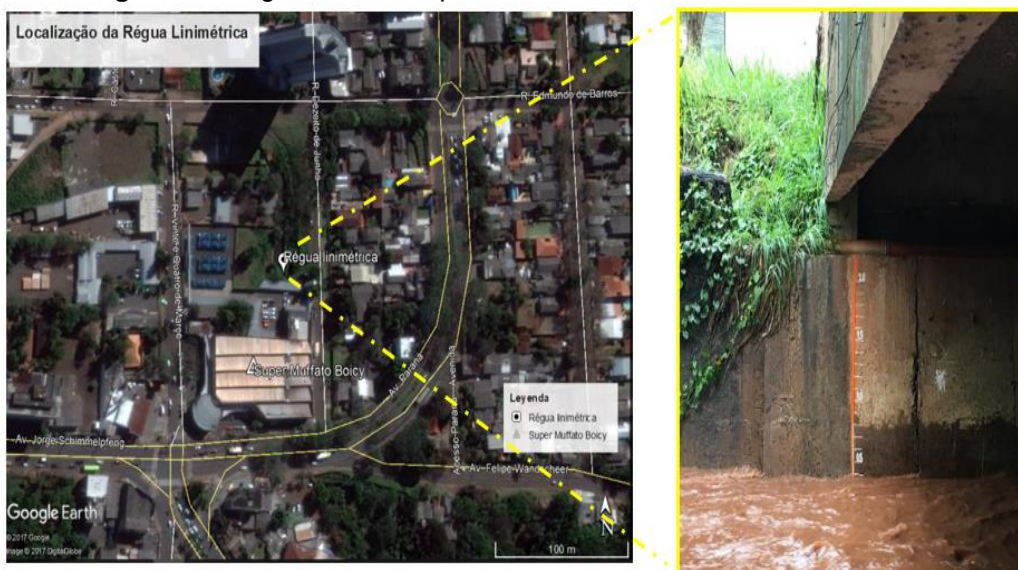
Figura 22: Régua linimétrica para medir o N.A. máxima de um evento.
