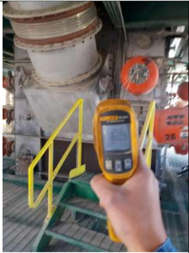
**Fotografía 6:** Toma de temperatura del Riser y calcinador.
