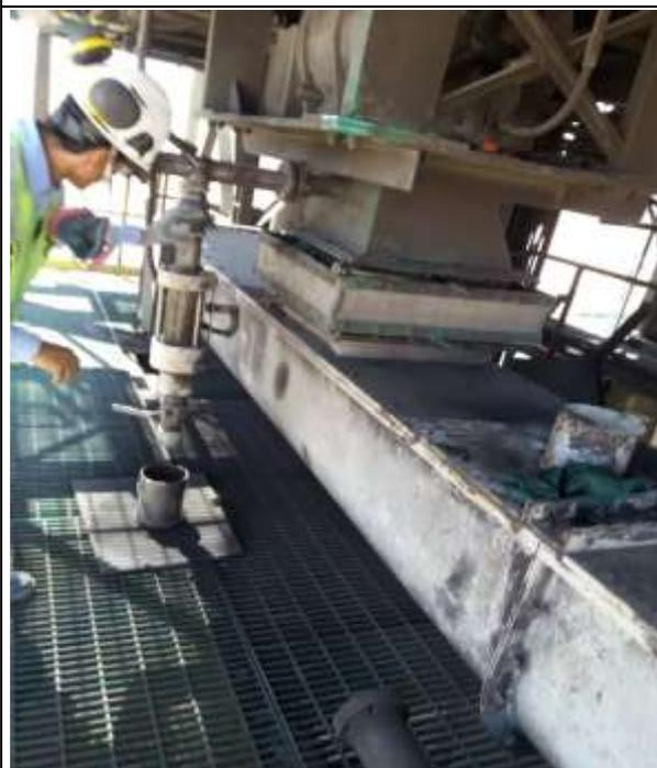
**Fotografía 3:** Medición de la temperatura del carbón de alimentación.
