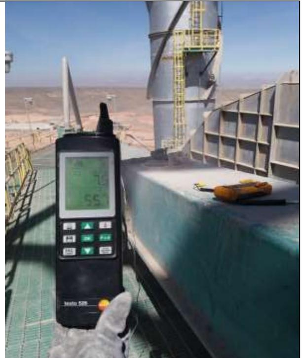
**Fotografía 2:** Medición de la temperatura de la harina de alimentación.
