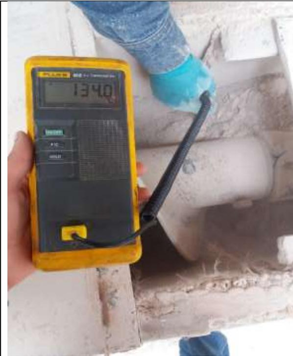
**Fotografía 1:** Medición de la temperatura del polvo.
