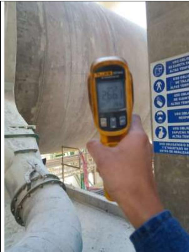
**Fotografía 5:** Toma de temperatura del horno rotatorio.
