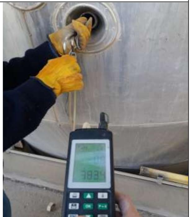
**Fotografía 4:** Medición de la temperatura y presiones de los gases de exceso.
