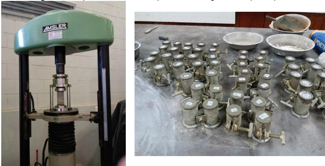
Figura 25. Máquina de ensaio de compressão e moldagem dos corpos de prova.
