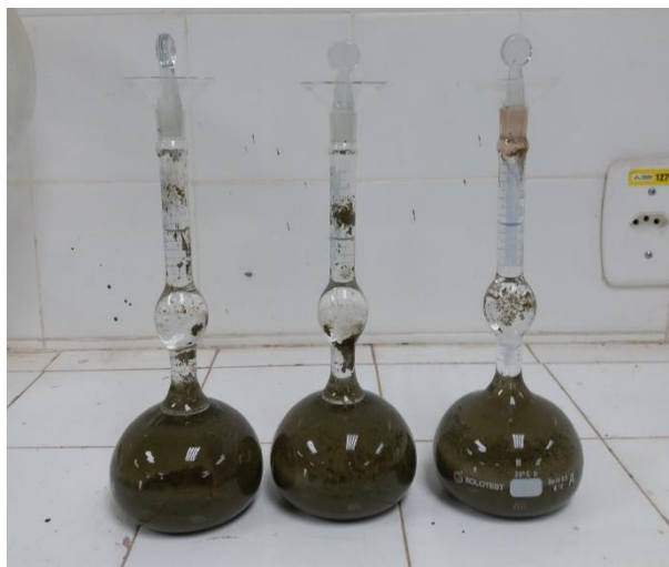
Figura 17. Ensaio de massa específica do cimento no frasco de Chapman
