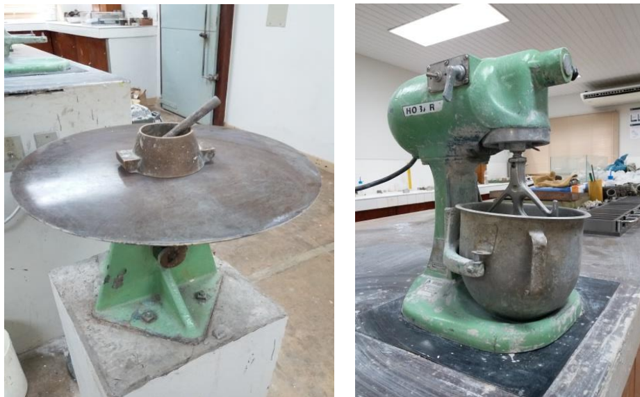
Figura 24. Mesa, molde tronco-cônico, soquete para ensaio de consistência e misturador mecânico.
