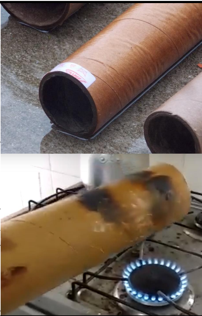
Figuras 43 e 44: experiências sobre o papelão beneficiado quimicamente com a aplicação de policloreto de vinila e poliuréia (KAWAJI, 2015)
