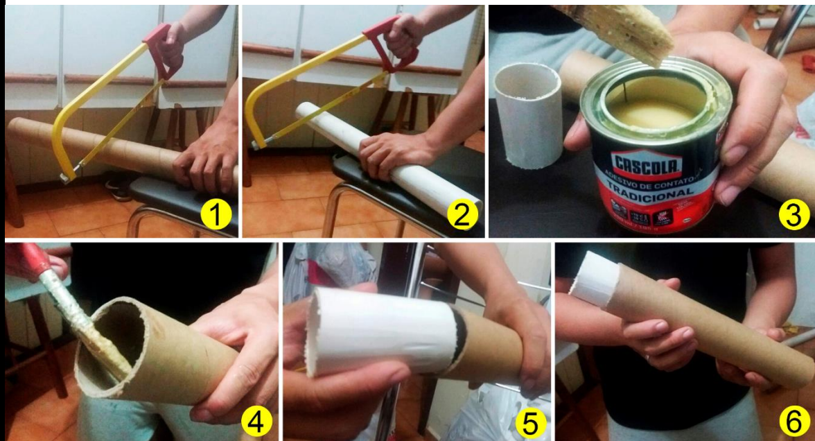
Figura 69: processo de fabricação do módulo macho-fêmea em papelão e pvc (KAWAJI, 2017)
