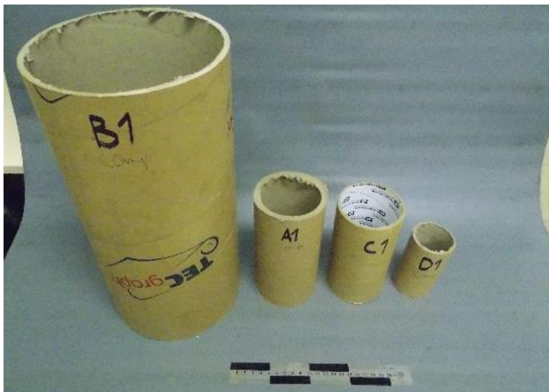
Figura 37: tubos de papelão selecionados para os testes mecânicos realizados no laboratório de concreto da Itaipu Binacional (KAWAJI, 2015)
