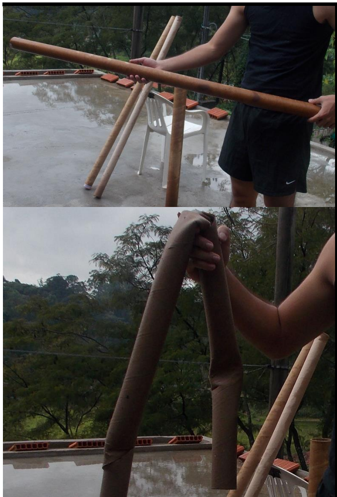
Figuras 38 e 39: testes de resistência do papelão à água (KAWAJI, 2015)
