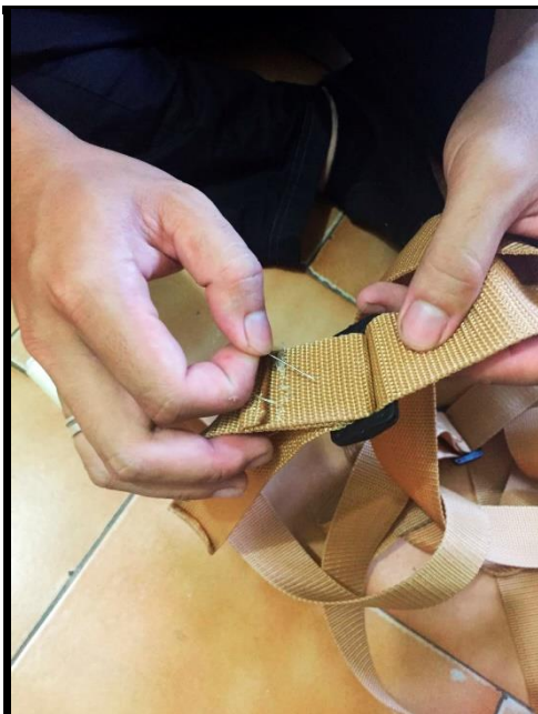
Figura 107: processo de elaboração do elemento de transporte por cordas ajustáveis (KAWAJI, 2017)
