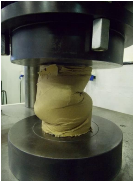
Figura 4: teste de compressão com tubo de papelão realizado em projeto de extensão desenvolvido na UNILA (KAWAJI e VETTORAZZI, 2015)
