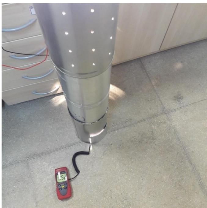
**Figura 7: Gaiola de Faraday com simulador solar ajustado para medidas com luz, radiação incidente de  $1000 \text{ W/m}^2$  [Autor].**
