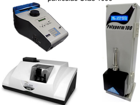
Figura 4.2. Equipamento utilizados para realizar a granulometria do resíduo a) Autopicnômetro Quantachrome Ultrapyc 1200e b) Bancada automatizada Polyperm 100 e c) Analista de dimensão de partículas Cilas 1090
