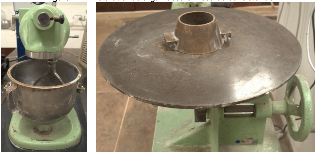
Figura 4.7. Misturador de argamassa e mesa de consistência
