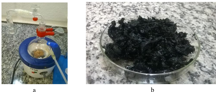
Figura 3 – Síntesis del ABPBI, a) Esquema laboratorial, b) Fibras de ABPBI obtenido
